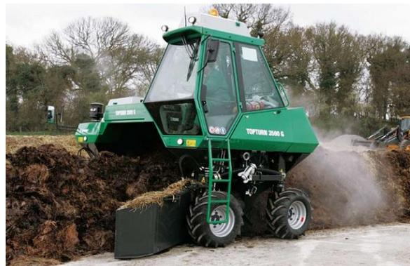
Abbildung 36: Mögliches Umsetzfahrzeug für die Nachrottefelder [69]
