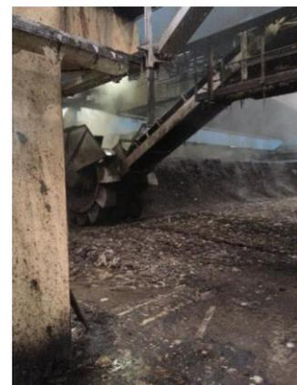
Abbildung 10: Blick auf eine Rottehälfte mit Umsetzer Wendelin®
