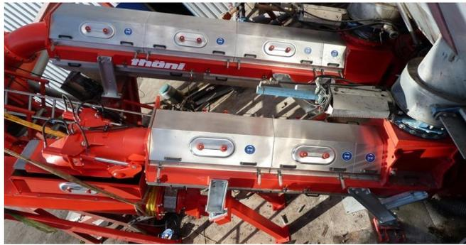
Abbildung 21: Blick auf ein Schneckenpressenpaar
