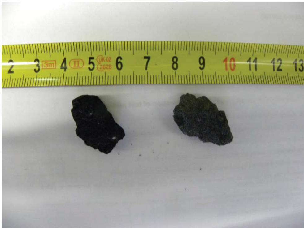
Abbildung 3-5: Kokskörner rechts vor und links nach der Reaktion
