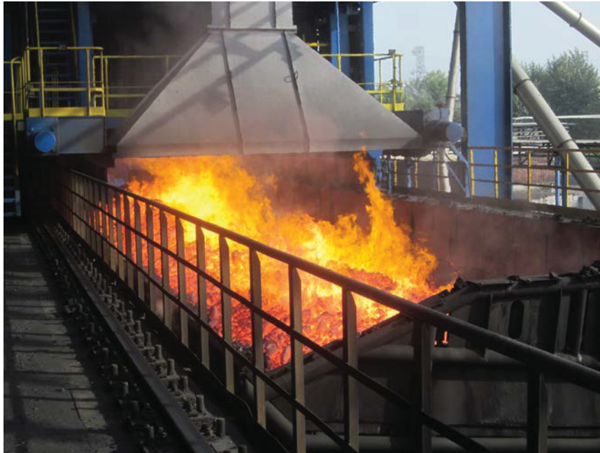
Abbildung 2-7: Abbrand des Kokes nach dem Ausdrücken
