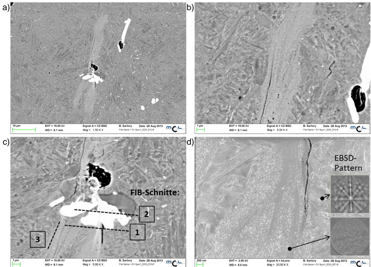
Abbildung 7.20: REM Gefügeaufnahmen eines BW mit a) Übersicht, b) Detail des oberen, c) Detail des mittleren und d) des unteren Bereiches. In c) sind zusätzlich die Positionen von FIB Schnitte eingezeichnet und in d) Pattern einer EBSD Messung im Bereich des BWs sowie der Matrix dargestellt.
