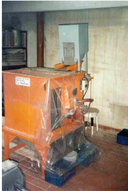
Bild 4.2: IFE-Scheider mit Staubschutz
