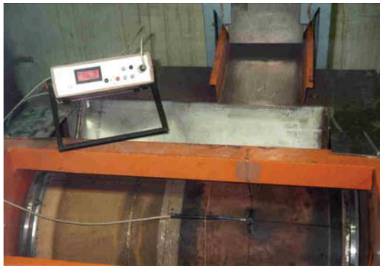
Bild 4.3: IFE-Scheider mit Hall-Sonde
