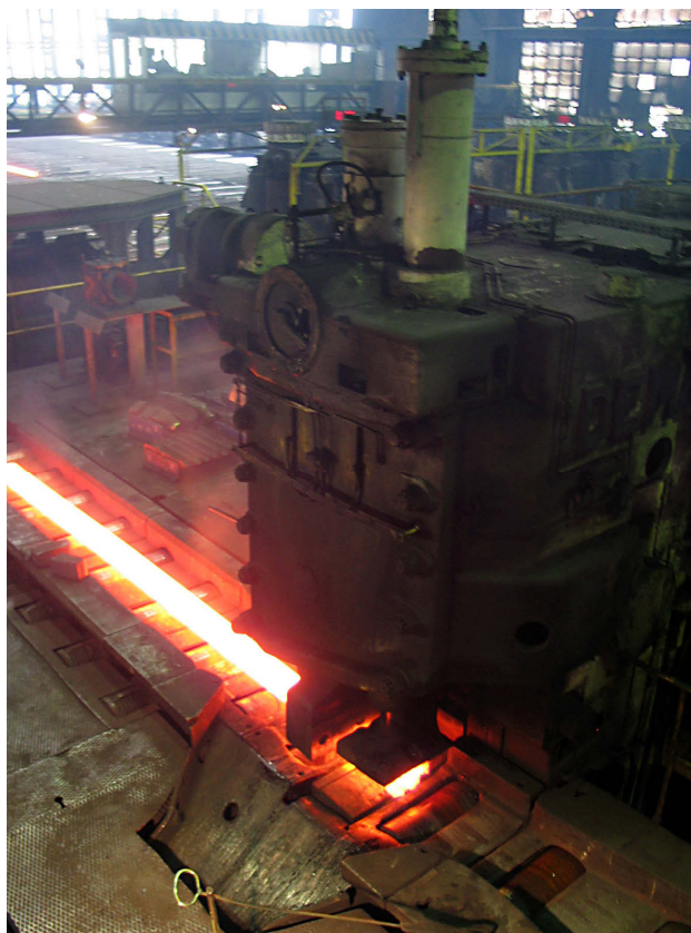
Abbildung 3-15: Blockschere beim Schneiden des Walzgutes
