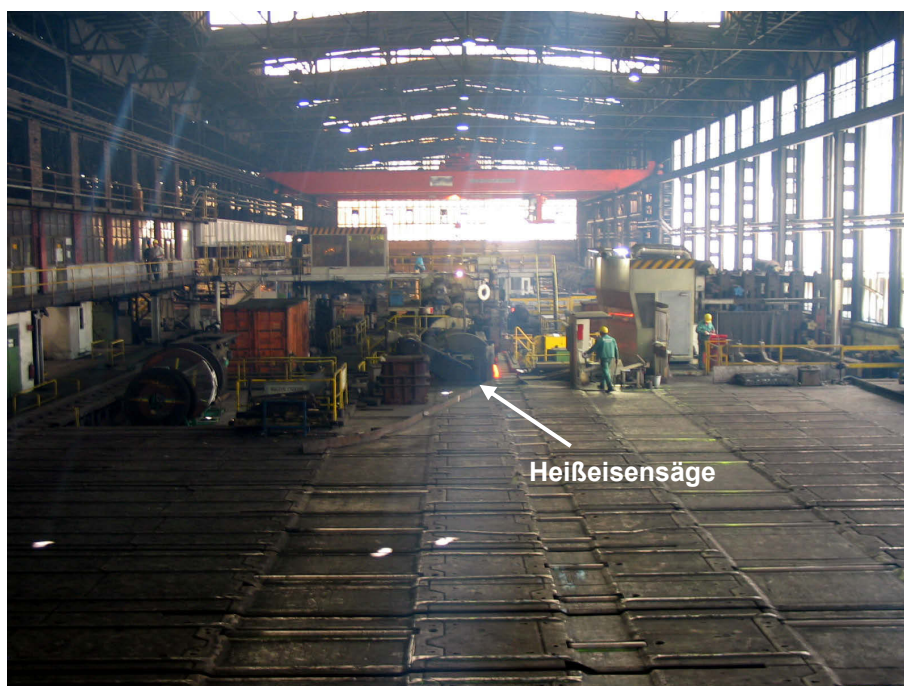
Abbildung 3-18: Blick von der Grobstrecke auf die Heißeisensäge
