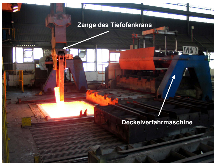
Abbildung 3-11: Tiefen Kran beim Ziehen eines Blockes aus dem Tiefofen
