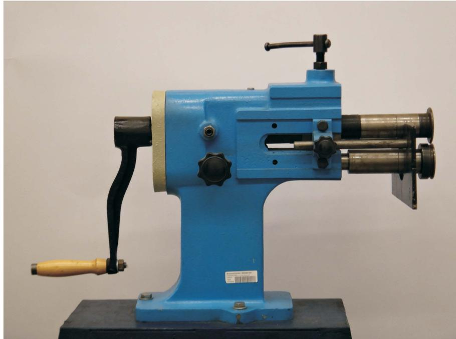
**Abbildung 4.28:** Sickenmaschine: Handbetriebene Sickenmaschine ohne Niederhalter zur Herstellung von unterschiedlichsten Sickenformen in Blechbauteilen.
