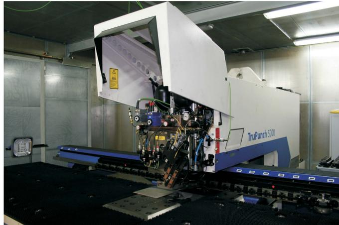
**Abbildung 4.29:** Blechbearbeitungsanlage TruPunch 5000: CNC gesteuerte Blechbearbeitungsanlage TruPunch 5000 der Firma Trumpf.
