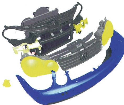
**Abbildung 2.15:** Modulbauweise: Modulare Bauweise am Beispiel der Frontpartie des VW Polo [42].
