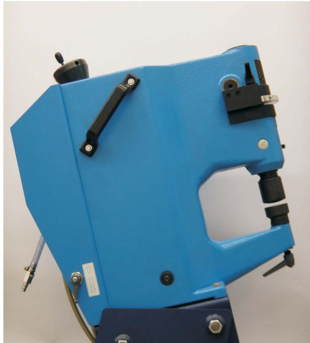
**Abbildung 4.20:** Kraftformer KF170: Pneumatisch betriebene Umformmaschine, mit der die Hohlprägungen eingebracht wurden.
