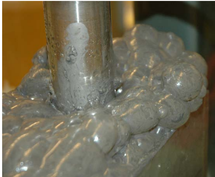
Abbildung 23: Unkontrolliertes Schäumen der neuen MEROS-Probe
