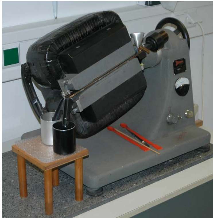
Abbildung 7: Isodynamikscheider der Bauart Frantz für paramagnetische Stoffe
