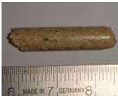
**Abbildung 10:** Holzpelletsprobe mit 6mm Durchmesser und einer Länge von ca. 25mm
