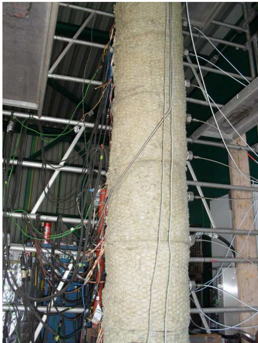
Abbildung 31: CSCR ® -Reaktor; Heizmattenverkabelung, Isolierung und Messstutzen mit Schlauchverbindungen
