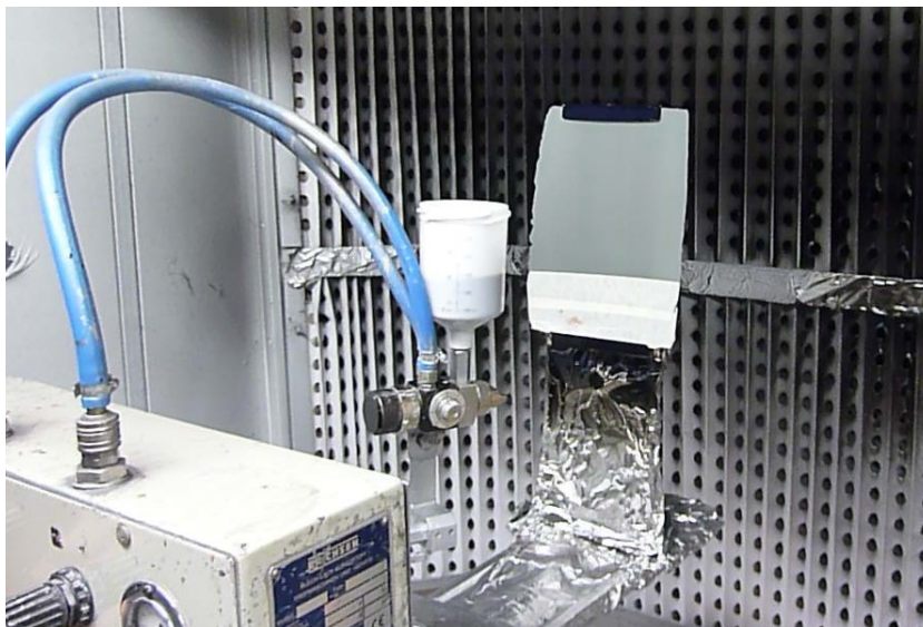
Abbildung 44: Lackierroboter mit Musterplatte
