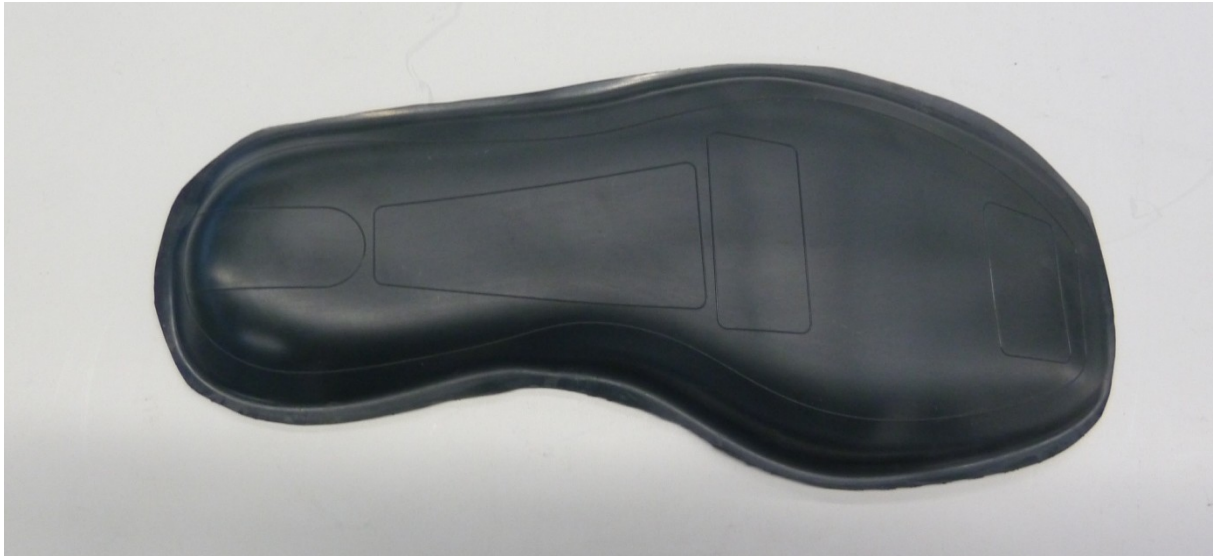
Abbildung 79: 3D Schuhsohle mit verbessertem Pulver und angepasstem Prozess
