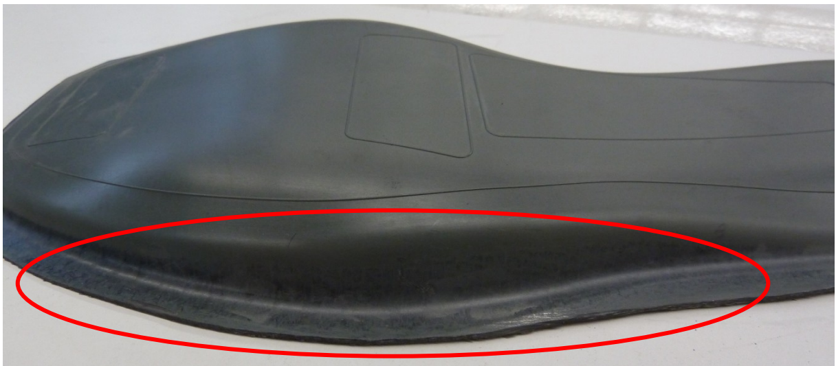
Abbildung 78: 3D Schuhsohle mit Fehlstellen im PIMC auf Grund der Schubbeanspruchung
