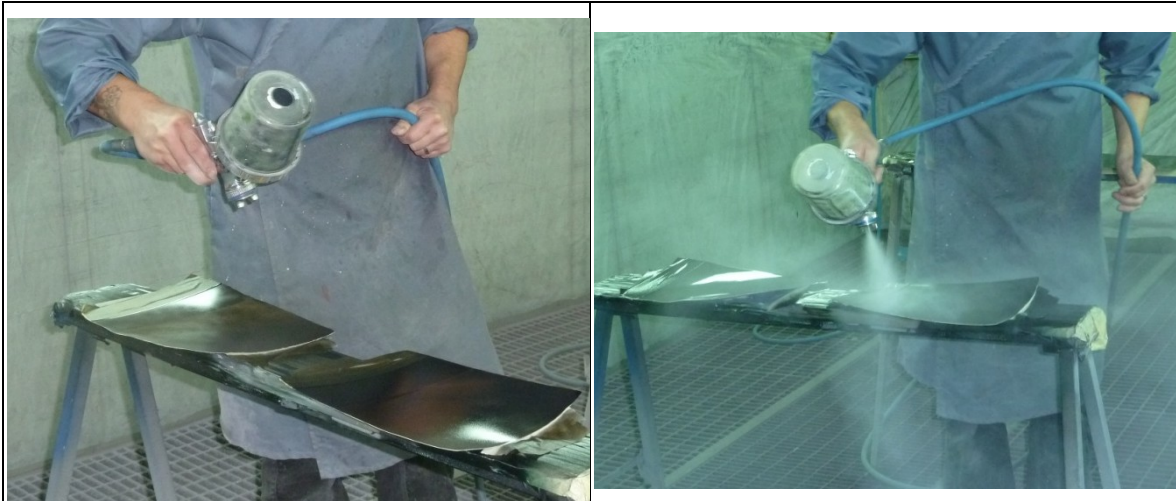
Abbildung 47: Lackierprozess bei Paint Attack: Lackierung
