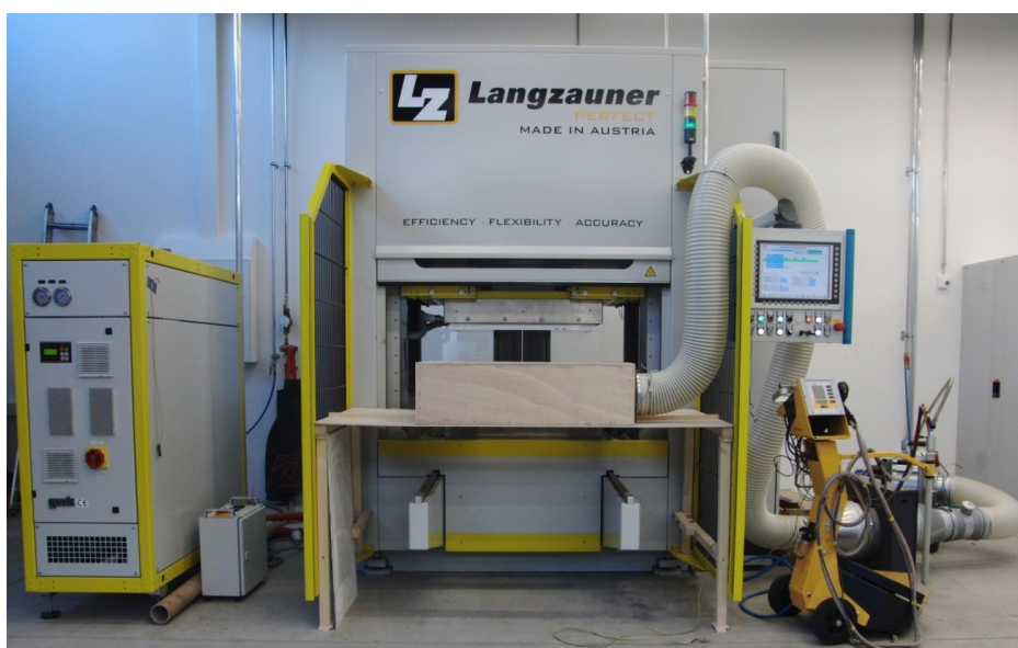
Abbildung 17: Presse mit Temperiergerät (links), Absauganlage und Pulverpistole (rechts)
