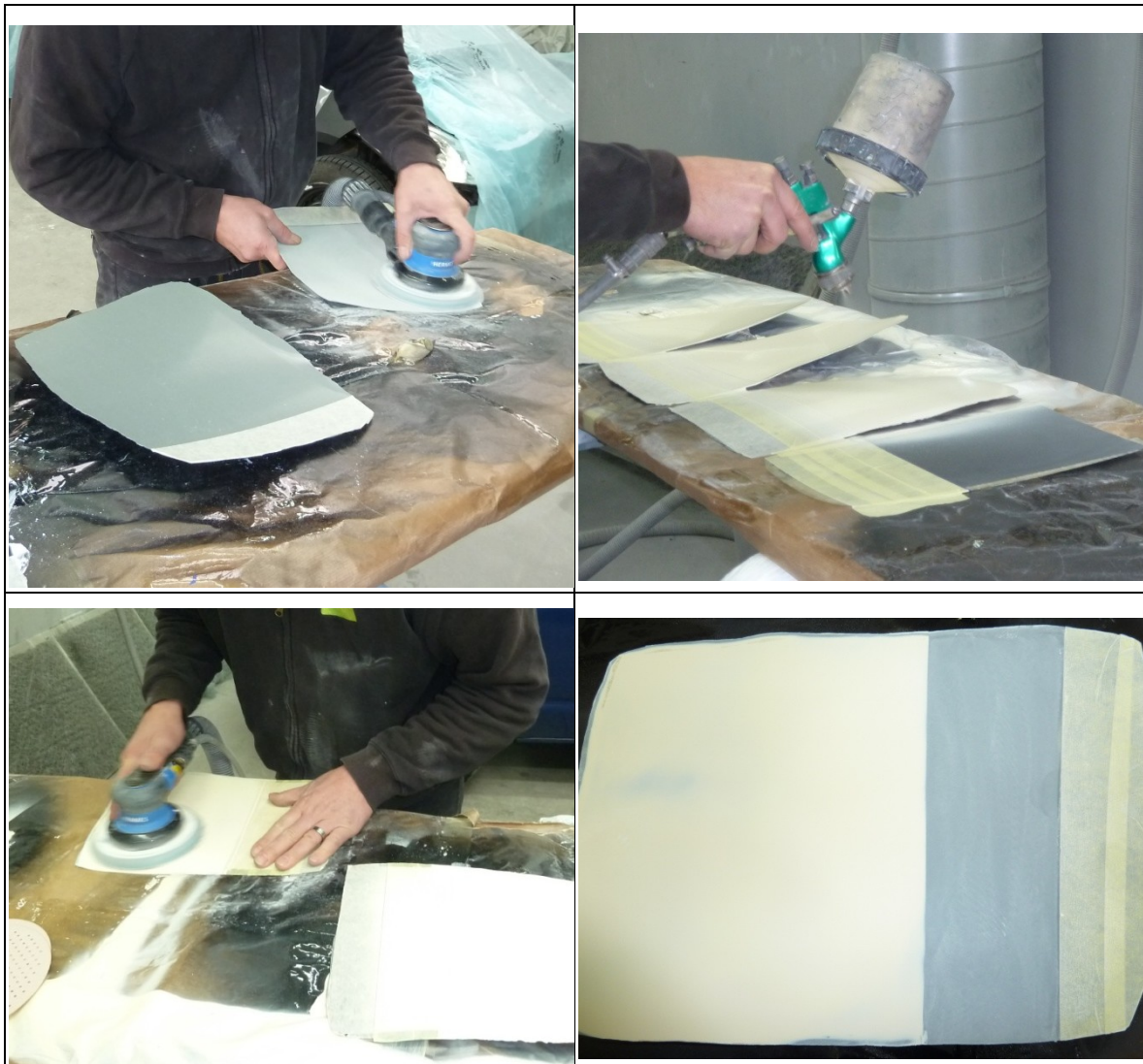
Abbildung 46: Lackierprozess bei Paint Attack: Vorbereitung und Auftrag des Füllers
