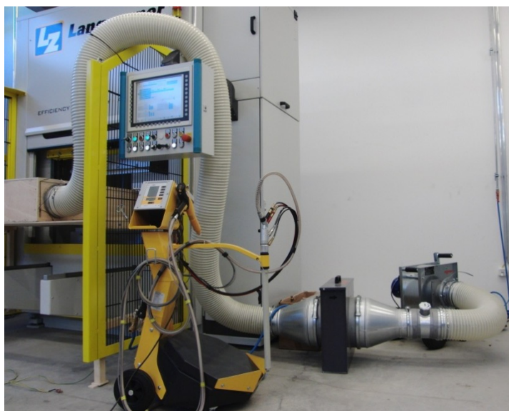
Abbildung 33: Pulverabsauganlage an der Presse
