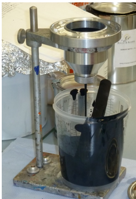
Abbildung 43: Viskositätsmessung nach DIN 53211
