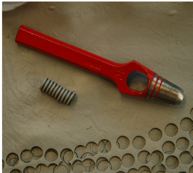
Abbildung 52: Ausstanzen von Scheibchen mittels Stanzeisen und Bilden von farblich alternierenden Stapeln [49]
