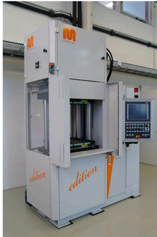
Abbildung 43: Kautschukspritzgießmaschine Maplan MTF 750/160 edition ohne eingebautes Werkzeug
