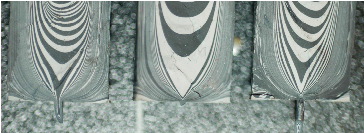
Abbildung 17: Visualisierung der Einlaufströmung ins HKR für die Mischung NBR 2, Links: v_K = 2,5 \text{ mm/s} , Mitte: v_K = 10 \text{ mm/s} , Rechts: v_K = 17,5 \text{ mm/s} [49]
