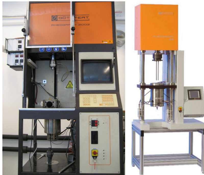
Abbildung 38: Hochdruckkapillarrheometer, links: Rheograph 2002, rechts: Rheograph 75 [6]
