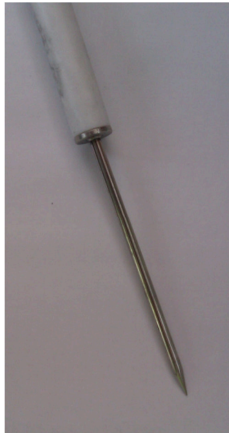
Abbildung 57: Dickes Thermoelement, Eigenbau IWZ Industribedarf Wilhelm Zastera GmbH
