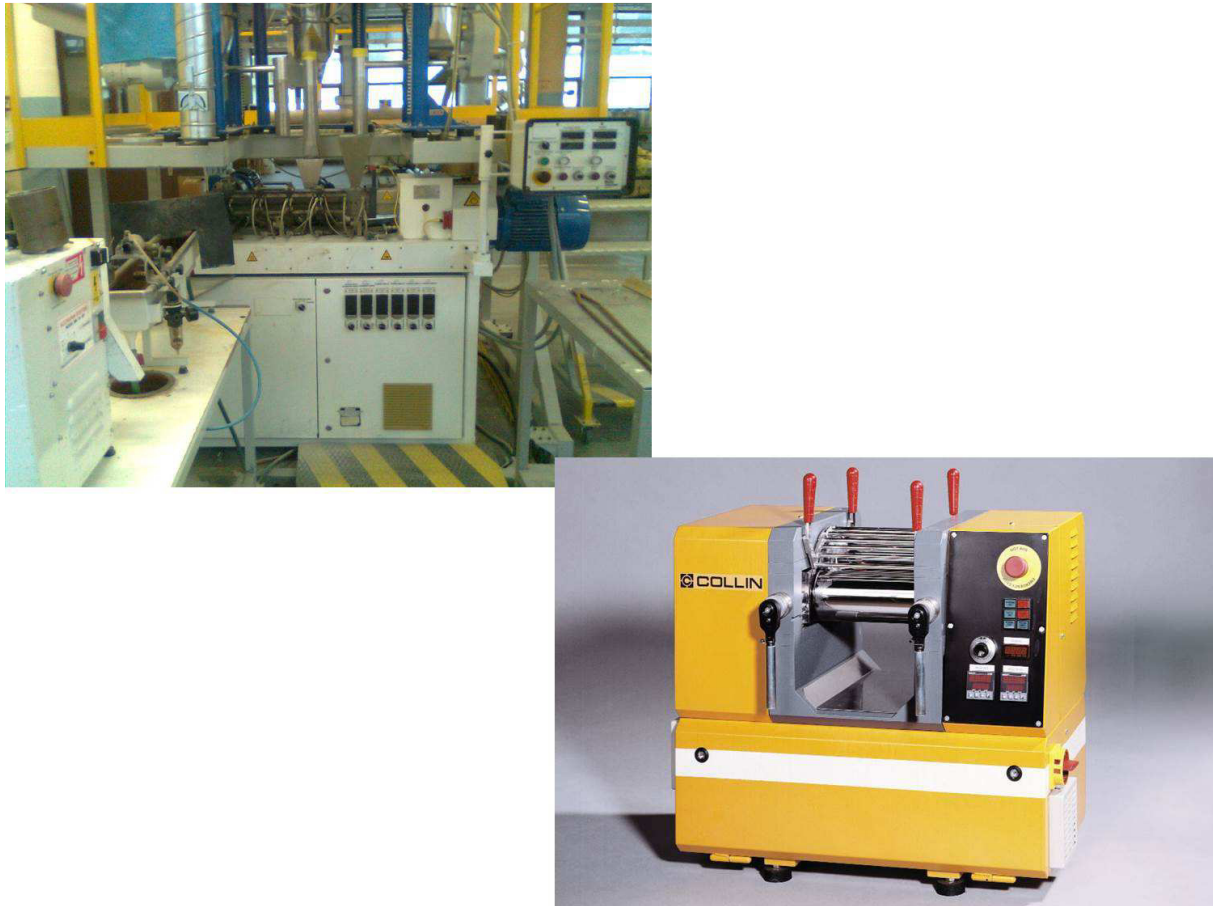
Abbildung 29: Kunststoffverarbeitungsmaschinen die zur Herstellung der PVC-Nanocomposites verwendet wurden (links: MKS 30 Buss Ko-Knetter, rechts: Zwei-Walzen Walzwerk W100T)
