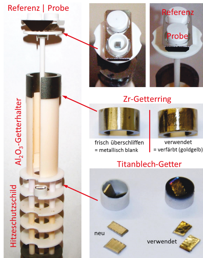
Abb. B-11: Vorbereiteter DSC-TG Probenträger mit Probe u. Referenz, sowie Zr- und Ti-Getter.
