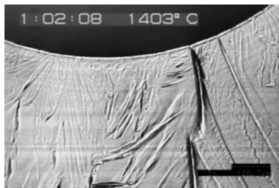
Abbildung 2-19: In-Situ Beobachtungen einer „massiven Transformation“ von \delta \rightarrow \gamma im HT-LSCM mit der konzentrischen Erstarrungsmethode einer Fe-0,08%C-1,55%Mn-0,30%Si-0,025%Al-0,010%Ti Legierung, Kühlrate 5\text{K/min} [60].
