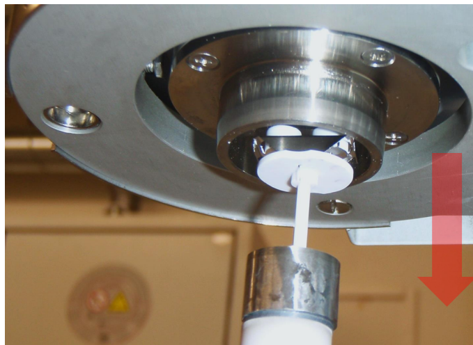
Abb. B-12: Kontrolle der Position des Probenträgers beim Herunterfahren des SiC-Ofens.
