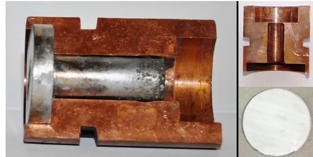
Abb. A-4: Zerlegte Kupfer-Schleuderkokille, inkl. beschichteter Prallplatte.
