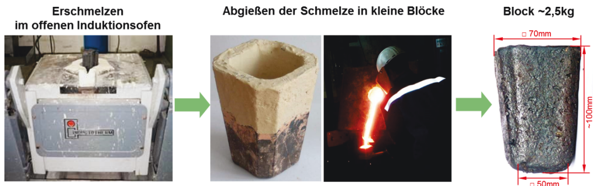
Abbildung 6-2: Herstellung der Modelllegierungen am offenen Induktionsofen.
