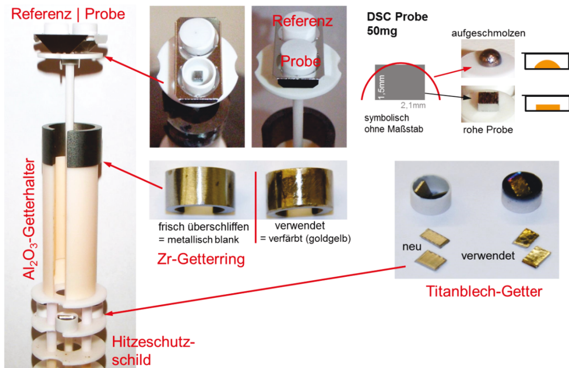
Abbildung 6-29: DSC-TG Probenhalter mit Zr- und Ti-Getter und den 50mg Proben.
