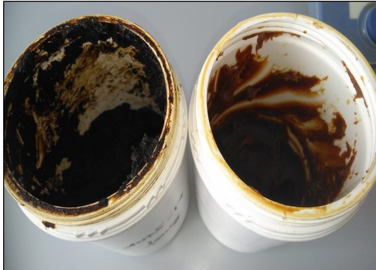
Abbildung 24: Öl-freier Feststoff (links) und Öl-Anteil (rechts) der Fettabscheider-Probe
