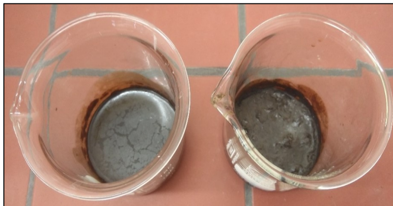
Abbildung 41: Biocrude nach dem Ausdampfen von Dichlormethan, links von Versuch 15, rechts von Versuch 16
