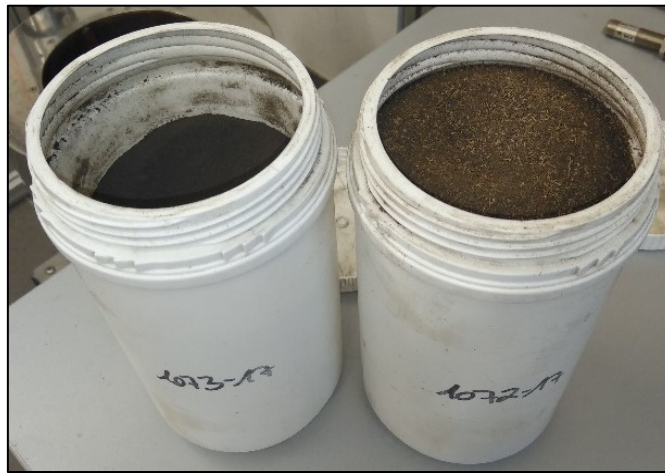
Abbildung 21: Zur Pulverform aufbereitete Proben: Klärschlamm aus Lannach (links) und Grünschnitt (rechts)
