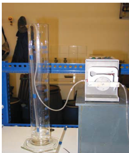
Abbildung 39: Inhibitorpumpe mit Messzylinder
