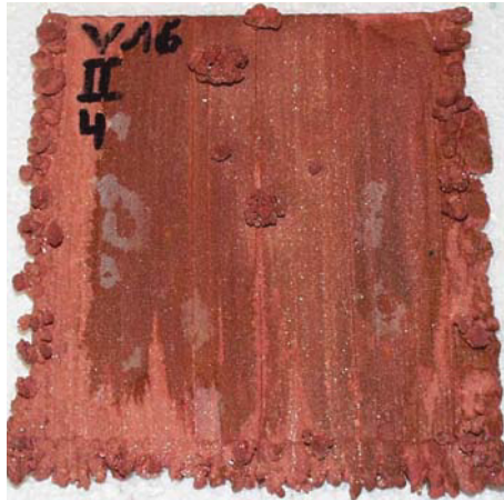
Abbildung 66: Kathodenfläche B mit Dendrit
