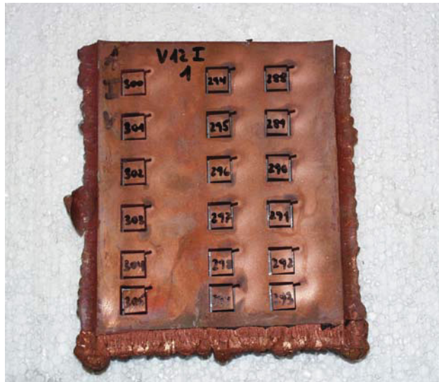
Abbildung 42: Rückseite einer geschnittenen Kathode
