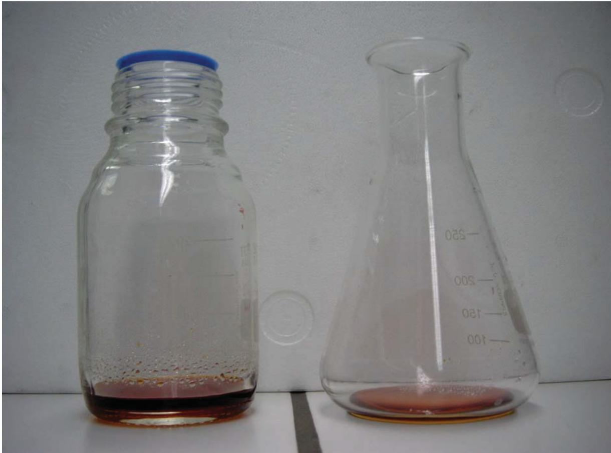
Abbildung: 6.1.6.1.: Probenahmegefäß und Erlenmeyerkolben mit vorgelegter Iodlösung
