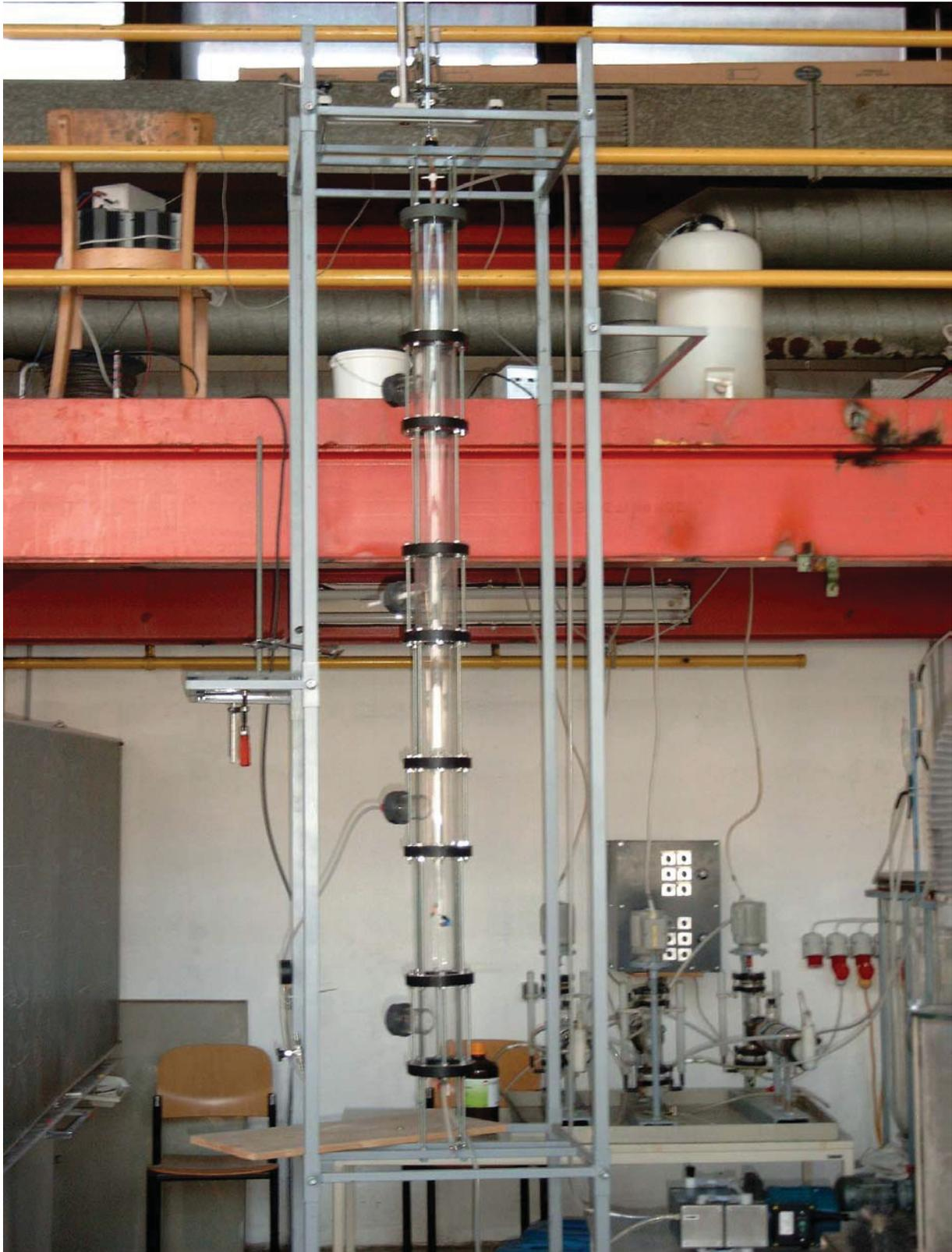
Abbildung: 6.1.4.1.: Stoffaustauschsäule während des Versuches
