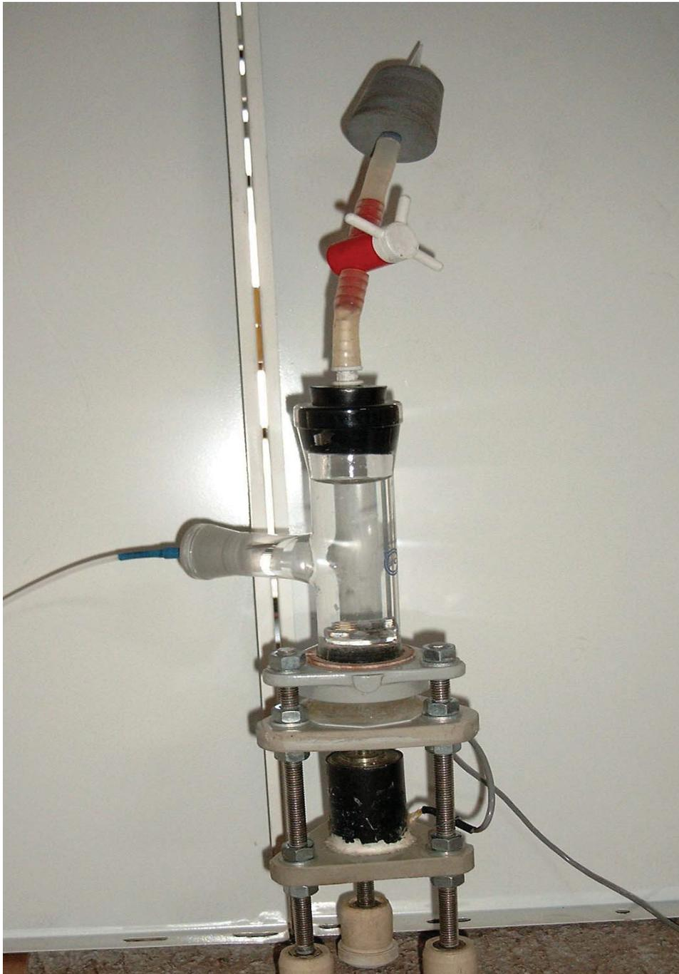
*Abbildung. 6.1.3.2.: Tropfengenerator während des Füllvorganges*
