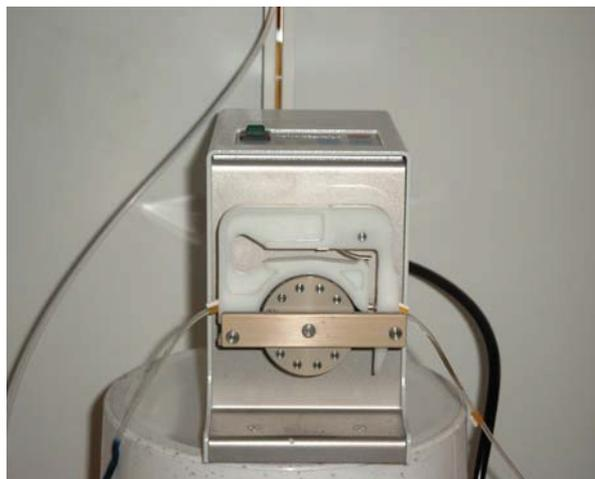
Abbildung 6.1.2.1: Präzisionsschlauchpumpe, Vorderansicht
