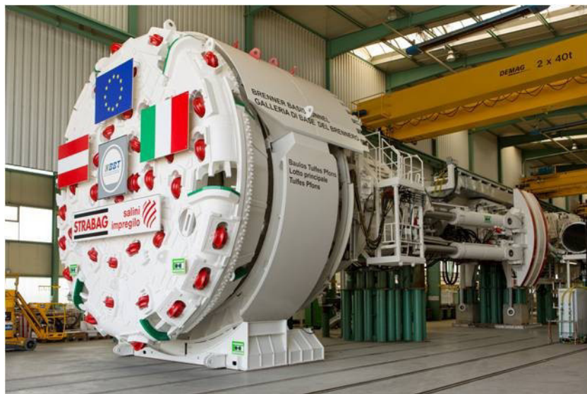
Abbildung 13: Tunnelbohrmaschine Baulos Tulfes-Pfons bei der Werksabnahme
