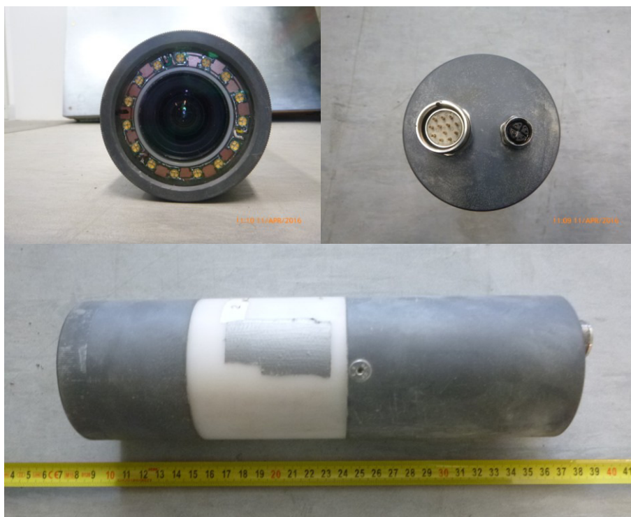
Abbildung 14: oben: Kameraeinheit mit Gehäuse; links unten: Anschlüsse für Stromversorgung und Datenübertragung; rechts unten: Kameraöffnung mit Linse und LED-Blitzring
