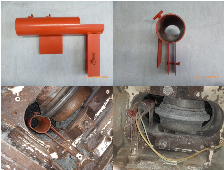
Abbildung 25: links und rechts oben: Halterung für das Kamerasystem; links unten: Halterung im eingebauten Zustand; rechts unten: Halterung inkl. angeschlossener Kameraeinheit
