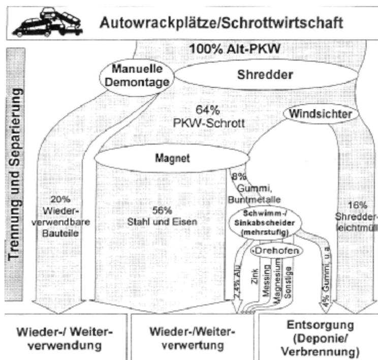
Abbildung 3.4: Verfahrensschritte und Verwertungswege beim Kraftfahrzeug-Recycling [1,S.3]
