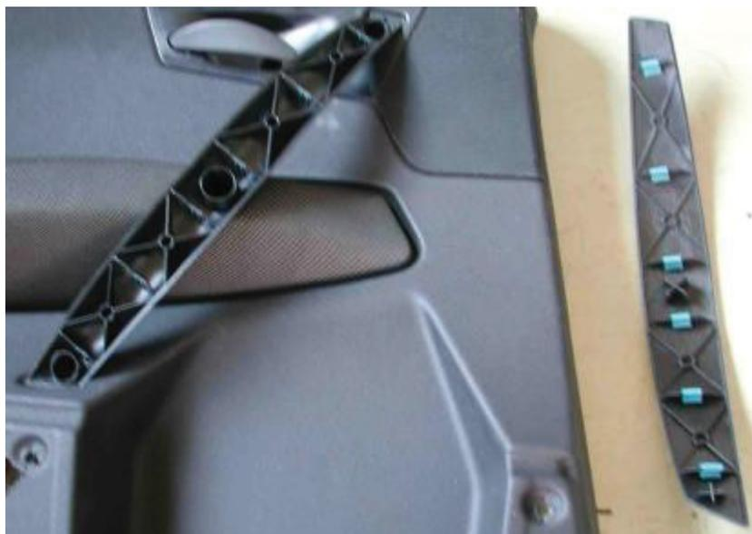
Abbildung 5.21: Metallclipse an der TVKL des BMW X3
