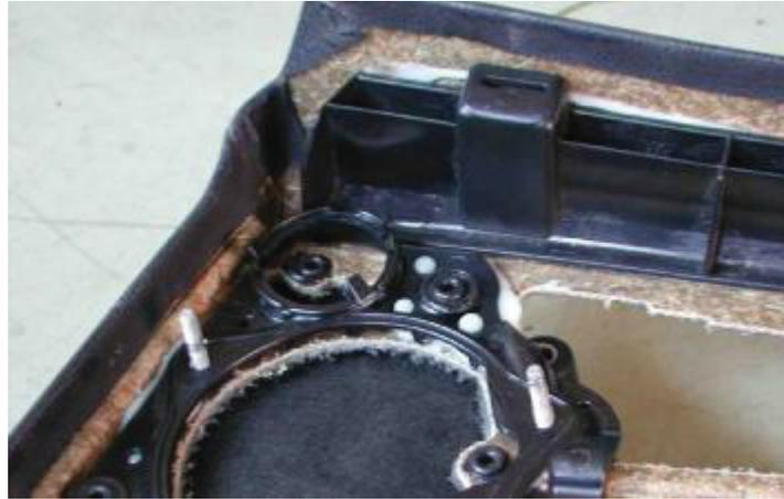
Abbildung 5.18: Flächige Verklebung von Kunststoffteilen in der BMW E83-TVKL
