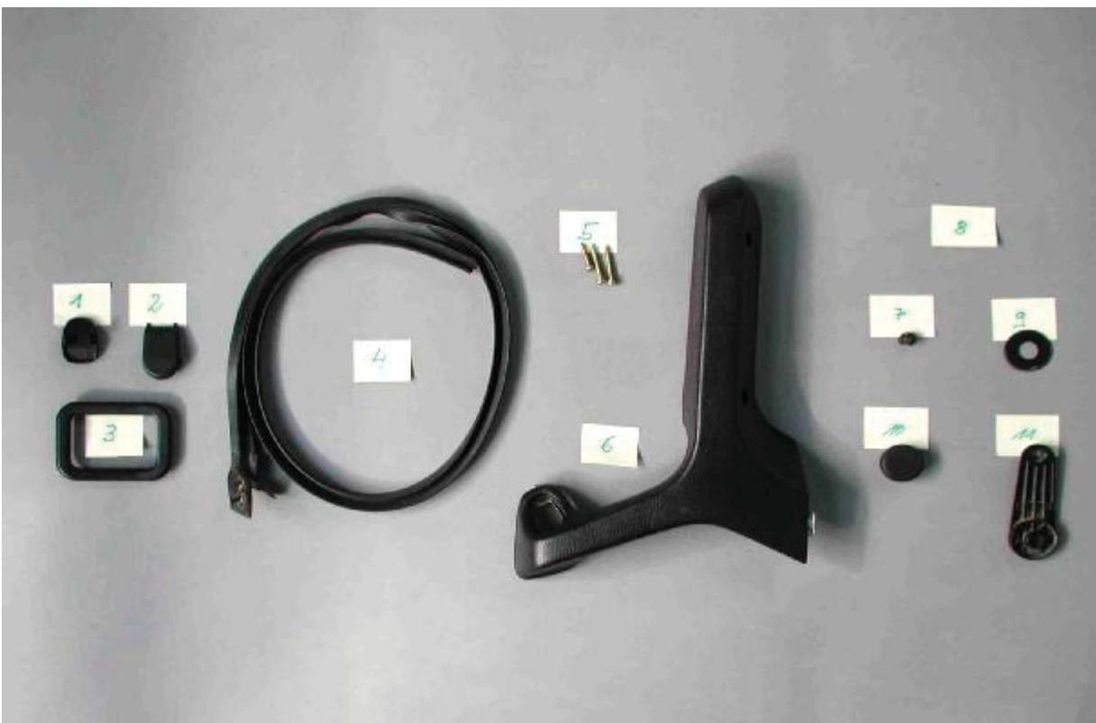
Abbildung 25: Bauteile der Demontageschritte 1 bis 11 des E30-Türmoduls
