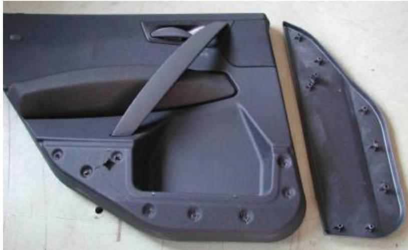
Abbildung 5.20: Demontierte Kartentasche des BMW E83 (Prototyp)
