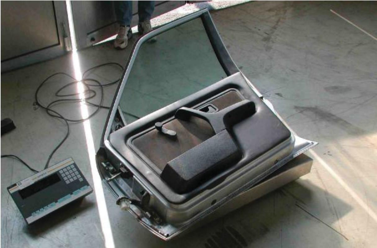
Abbildung 24: Wiegen des gesamten BMW E30-Türmoduls auf einer Standwaage
