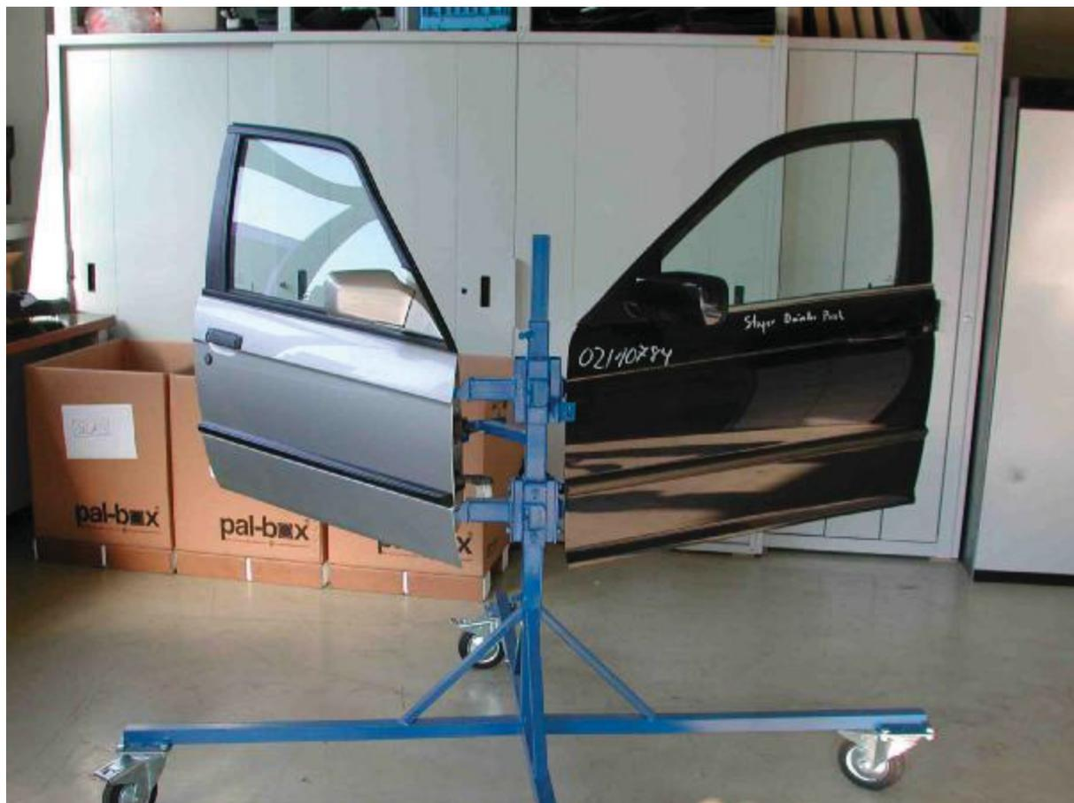
Abbildung 23: Türmodule des E30 (links) und des E46 (rechts) vor dem Demontageversuch
