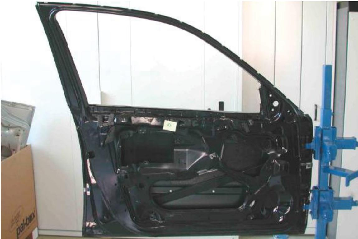
Abbildung 48: Rohbau der E46-Tür nach Komplettdemontage – Antidröhnbelag unlösbar geklebt
