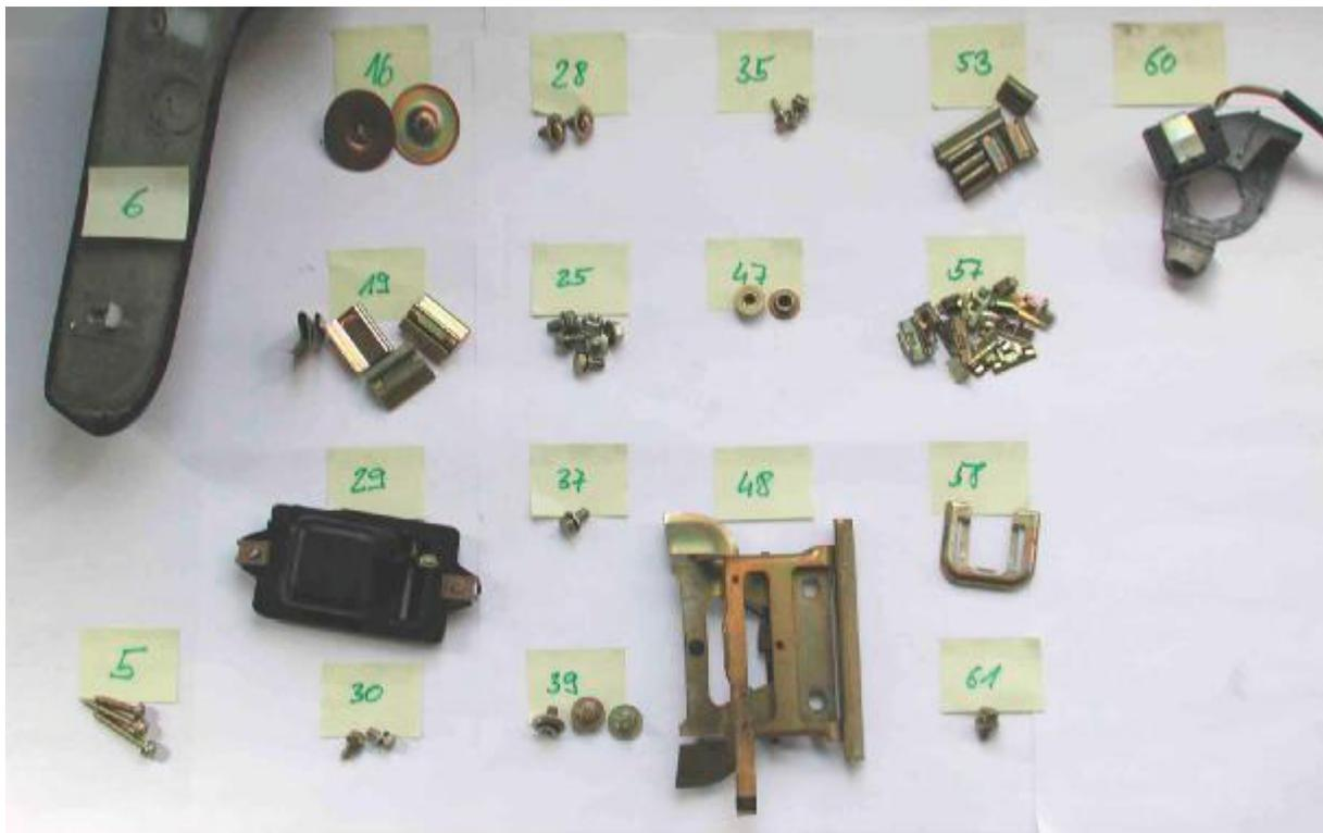
Abbildung 5.15: CrVI-Bauteile im Türmodul des BMW E30
