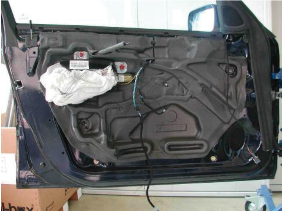
Abbildung 40: Türmodul nach Demontage der Türinnenverkleidung
