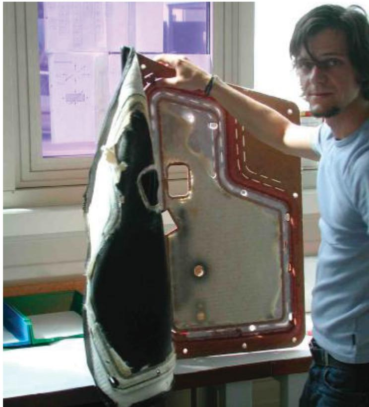
Abbildung 28: Weiterzerlegung der Türinnenverkleidung
