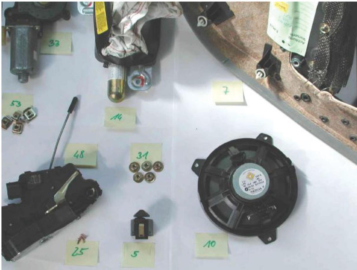
Abbildung 5.16: CrVI-Bauteile im Türmodul des BMW E46
