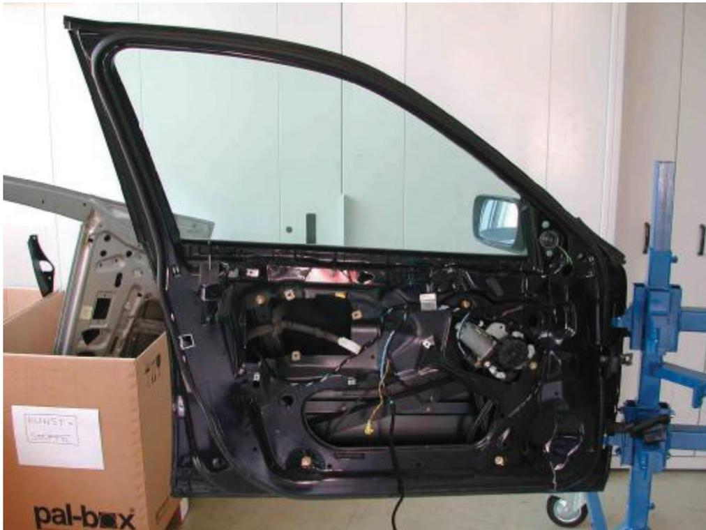
Abbildung 42: Türmodul mit freigelegten Cr(VI)-Clipsen und Schraubverbindungen
