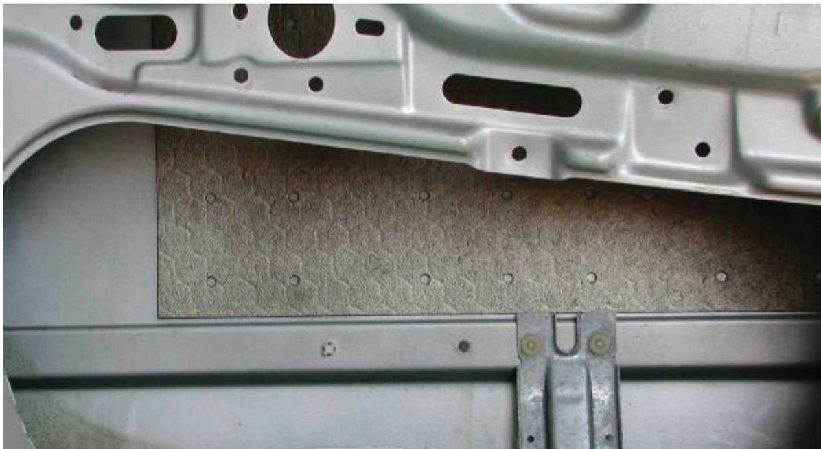
Abbildung 33: Detailansicht des unlösbar an den Rohbau geklebten Antidröhnbelages
