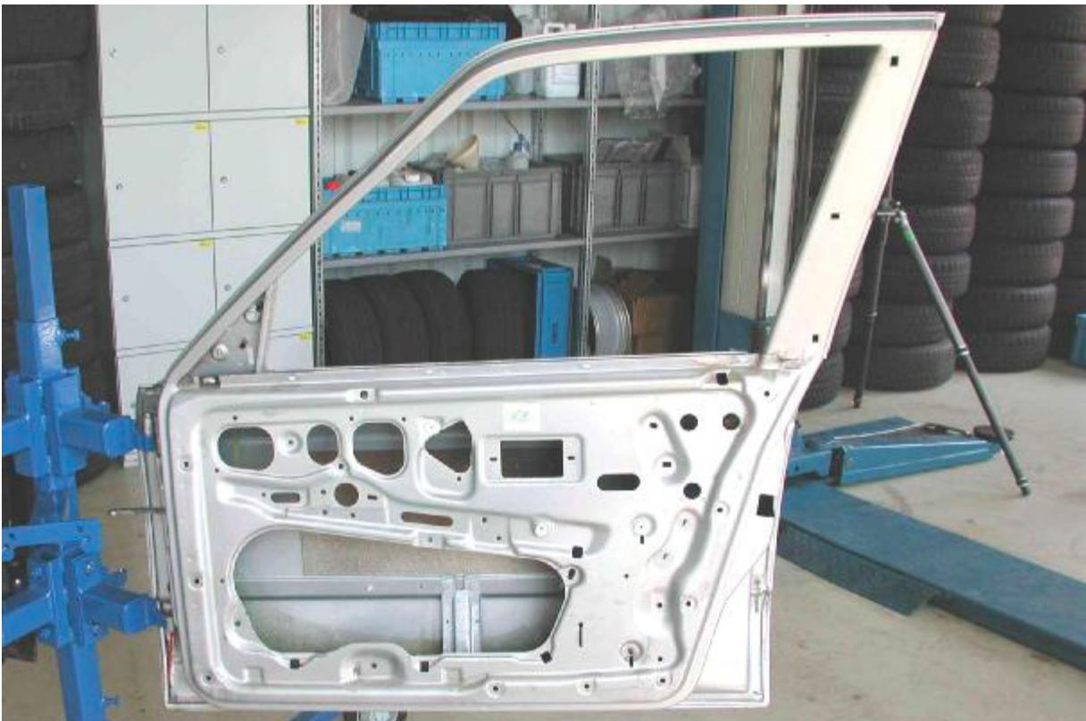
Abbildung 37: Demontageschritt 63 – Komplettdemontage der BMW-E30-Tür (Innenansicht)
