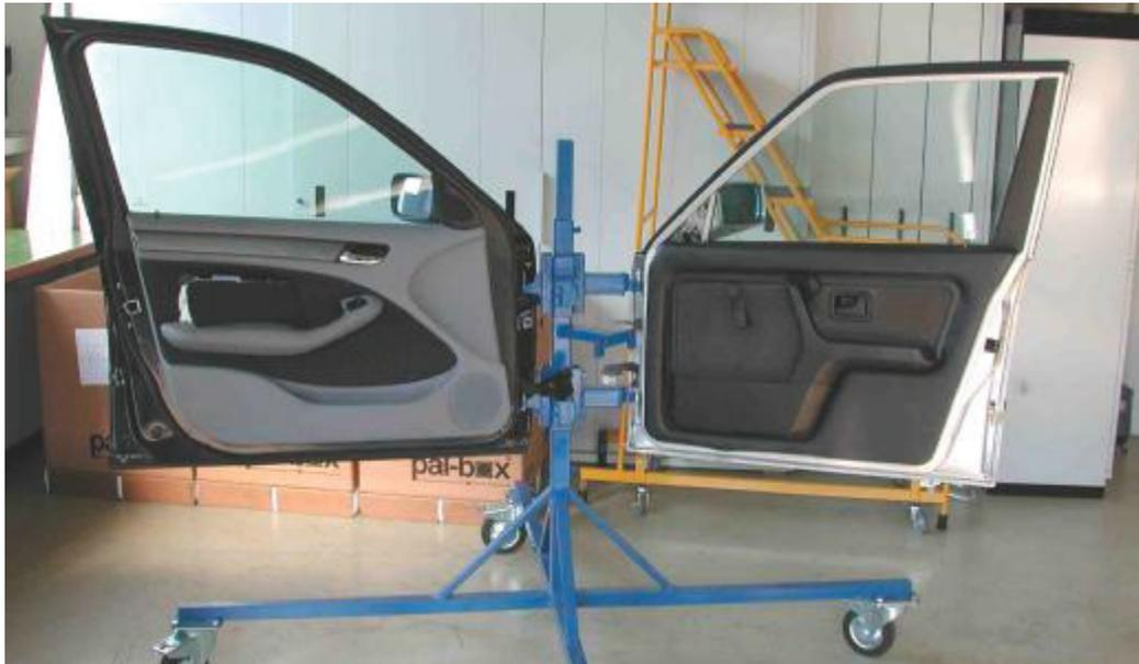
Abbildung 5.9: Montagegestell mit Türmodulen des BMW E30 (rechts) und BMW E46 (links)
