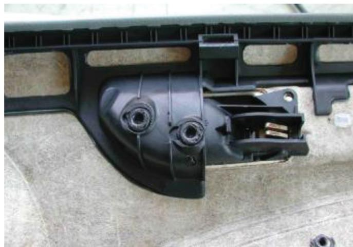
Abbildung 39: Detailansicht der aufgrund unlösbarer Schweiß- und Klebeverbindungen nicht weiterzerlegbaren Türinnenverkleidung
