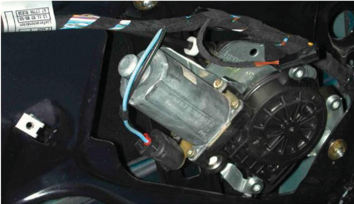
Abbildung 44: Cr(VI)-Verbindungen an Rohbau und Fensterhebermotor
