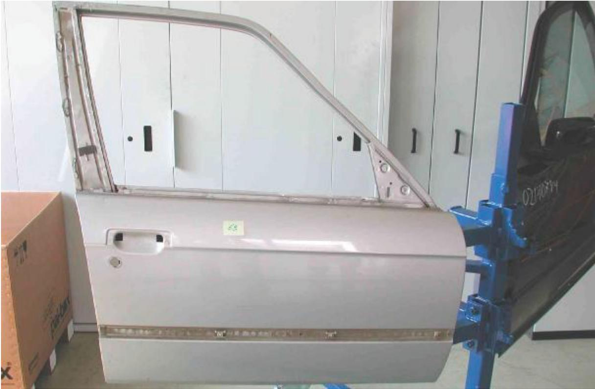
Abbildung 36: komplettdemontierter Rohbau der BMW-E30-Tür (Aussenansicht)
