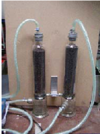
Abbildung 15: Trocknung des Gasstromes mit Silikagel (Rein- und Rohgas)
