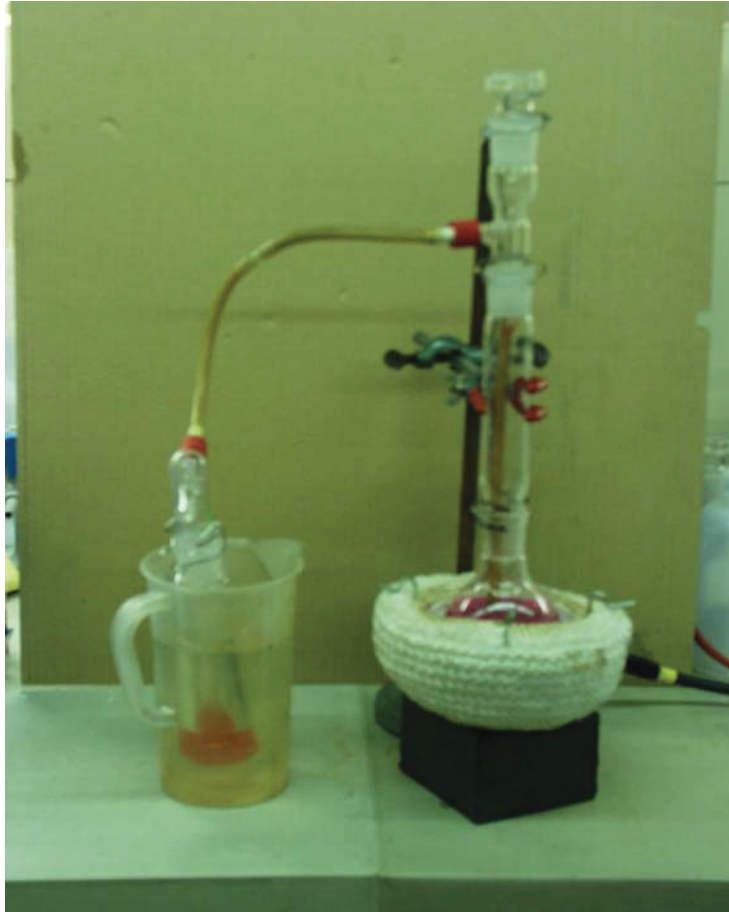
Abbildung 22: Apparatur zur Ammonium- Stickstoffbestimmung (Waschflasche mit Schwefelsäurevorlage und Destillationskolben)
