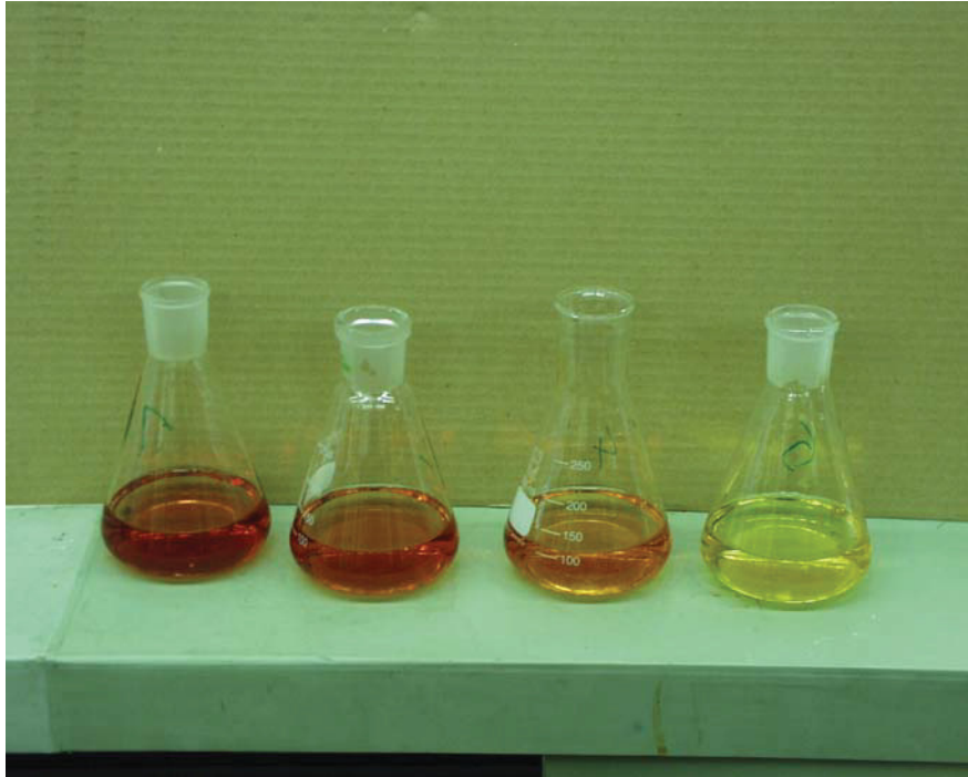
Abbildung 28: Unterschiedliche Verfärbung der Proben nach Zugabe der Chemikalien je nach Cyanidgehalt
