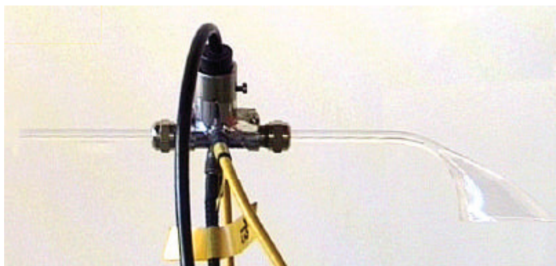
Abbildung 4.2.2: Absaugtrichterkapillare mit Faseroptik-Justierung und Lichtwellenleiter
