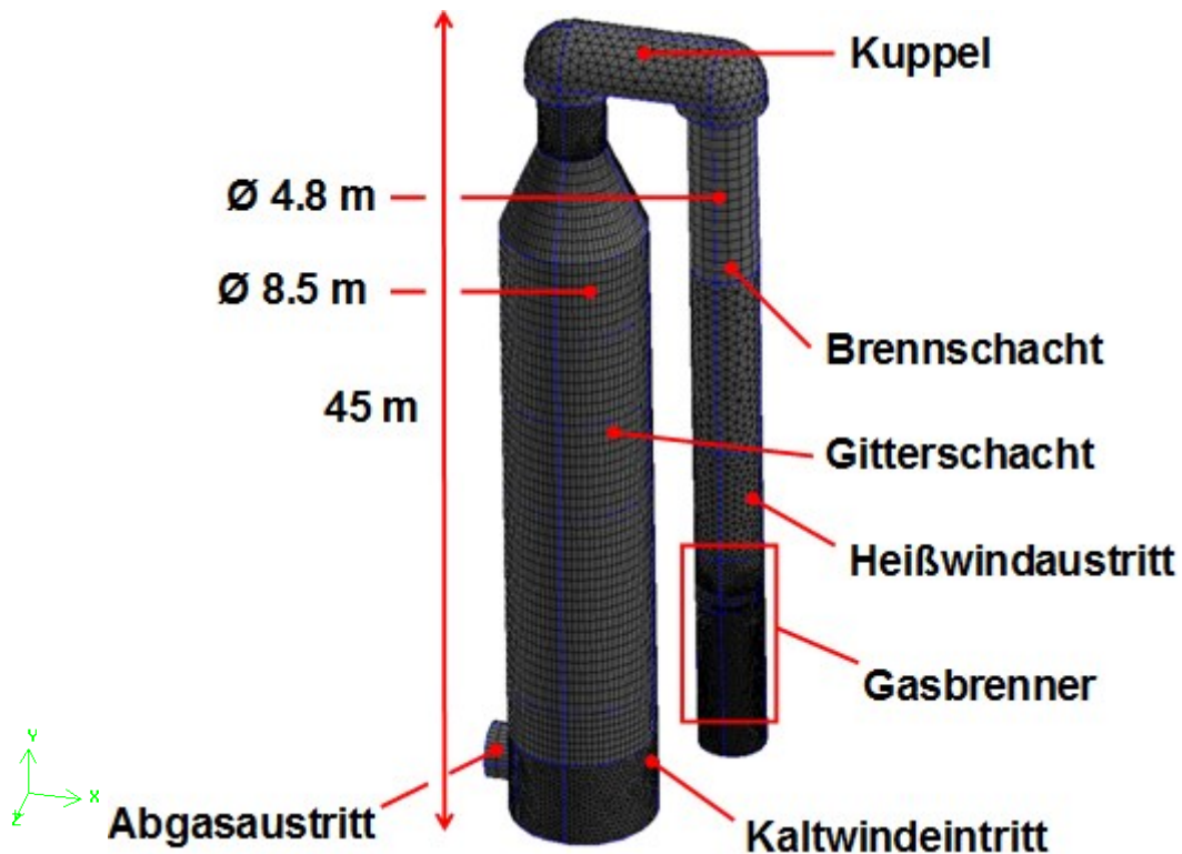
Abbildung 62: Netzgittermodell des Winderhitzers.
