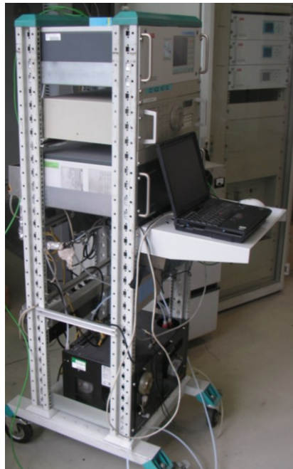
Abbildung 27: Gasanalyseesystem URAS 14 bestehend aus CO-, CO 2 -, NO x - und O 2 -Analysemodulen.
