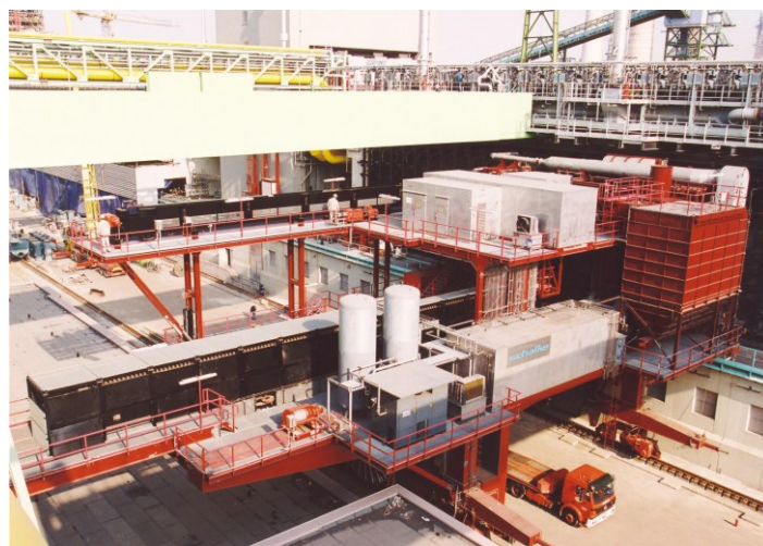
Abbildung 45: Koksdrückmaschine der Kokerei Schwelgern (Schalker Eisenhütte GmbH, 2012).
