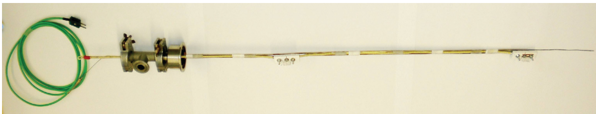
Abb. 4.15: Darstellung der Temperaturmesslanze mit Zündeinheiten
