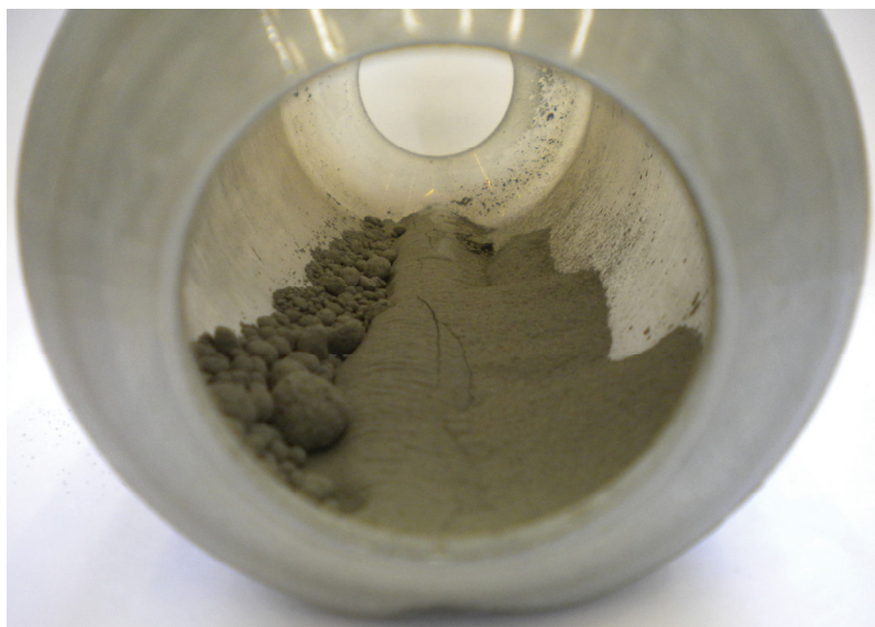
Abb. 4.19: Darstellung der Sintererscheinungen bei hohen Behandlungstemperaturen (Versuch 31, Schlamm B1)
