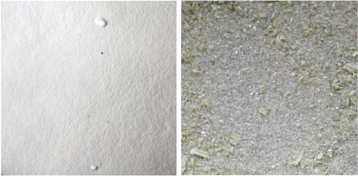
Abb. 4.48: Gegenüberstellung von reinen (links) und verunreinigten (rechts) APT-Kristallen
