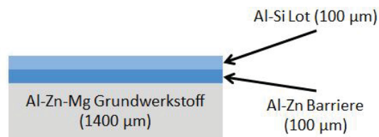
Abbildung 4.13: Schematischer Aufbau eines Verbunds auf Basis einer modifizierten 7020-Legierung
