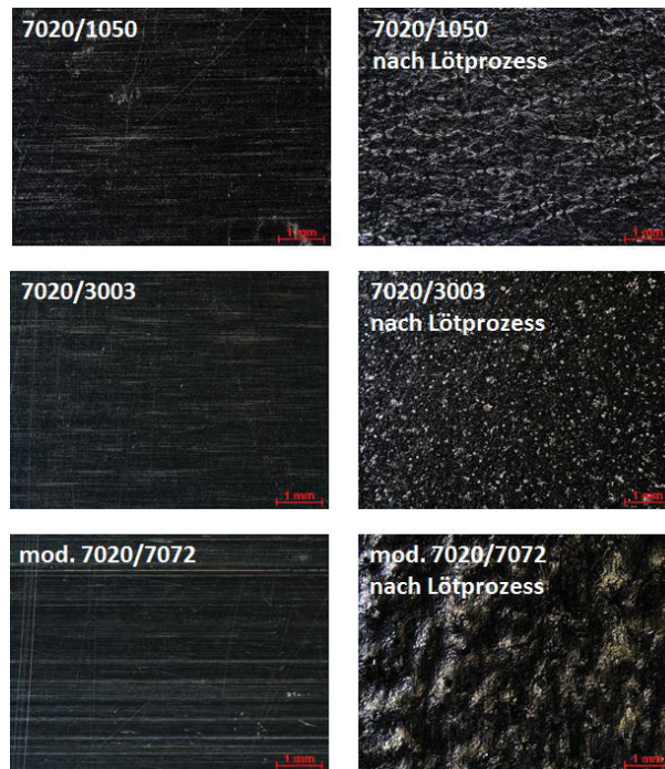
Abbildung 4.7: Oberflächen-REM-Topographie in walzharten und verlötetem Zustand
