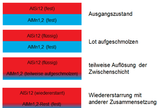
Abbildung 4.44: Einzelne Schritte der Auflösung der Zwischenschicht während der Verlötlung
