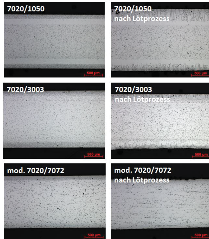
Abbildung 4.9: Querschliffe der Bleche in Walzrichtung zur Bewertung der Mikrostrukturänderung während der Verlötung-Übersicht
