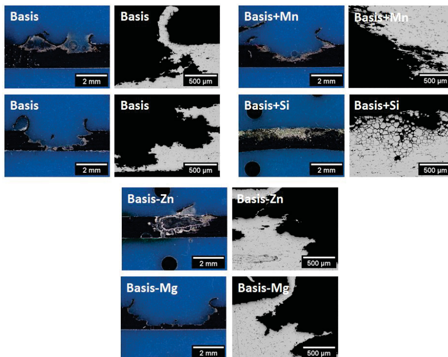
Abbildung 4.17: Querschliffe zur Bewertung der mikrostrukturellen Korrosionsmorphologie nach 30 Tage SWAAT
