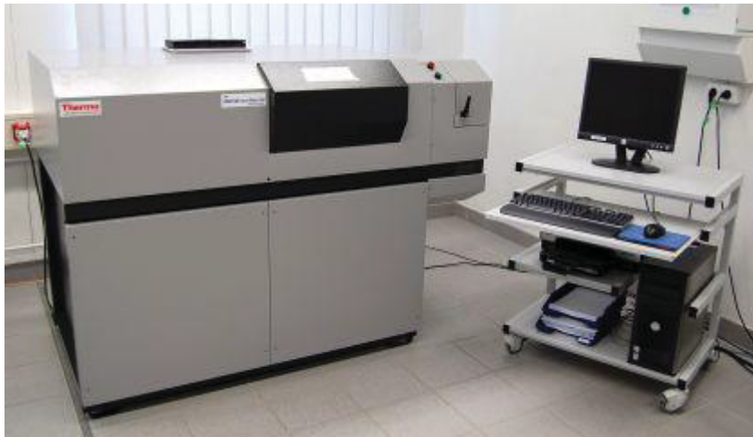
Abbildung 2-19: Optisches Emissionsspektrometer (Funkenspektrometer) [18]
