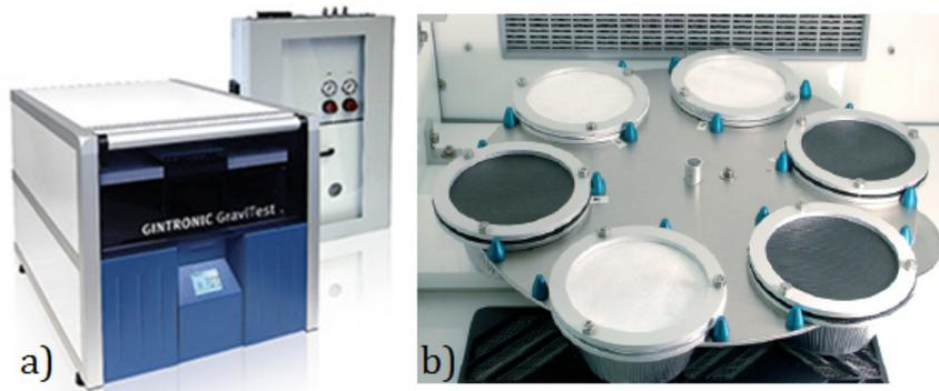
Abbildung III.3: Abbildung des a) Messsystems Gintronic GraviTest 6300 zur Bestimmung der Wasserdampfdurchlässigkeit von Filmen, Folien und Flächengebilden und b) seiner Messkammer.
