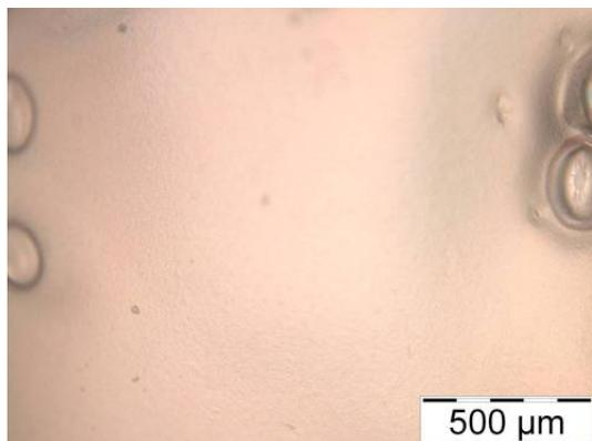
Abbildung IV.25c: PVOH(D)-Film mit 5 *phr* Hydroxypropylmethylcellulose bei 10-facher Vergrößerung.
