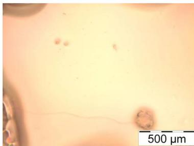
Abbildung IV.27a: PVOH(D)-Film mit 1 *phr* Ethylcellulose bei 10-facher Vergrößerung.
