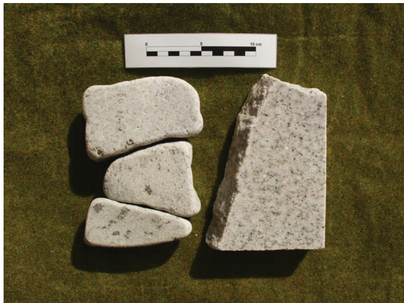
Abbildung 16: Fertige Polygonplatten (links) und Platte vor dem Trommeln (rechts)
