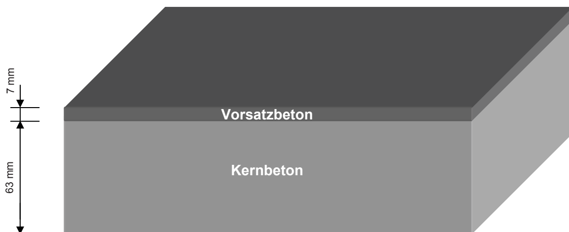
Abbildung 25: Schematischer Aufbau des Betonsteins „BELVEDERE exklusiv“ [3]
