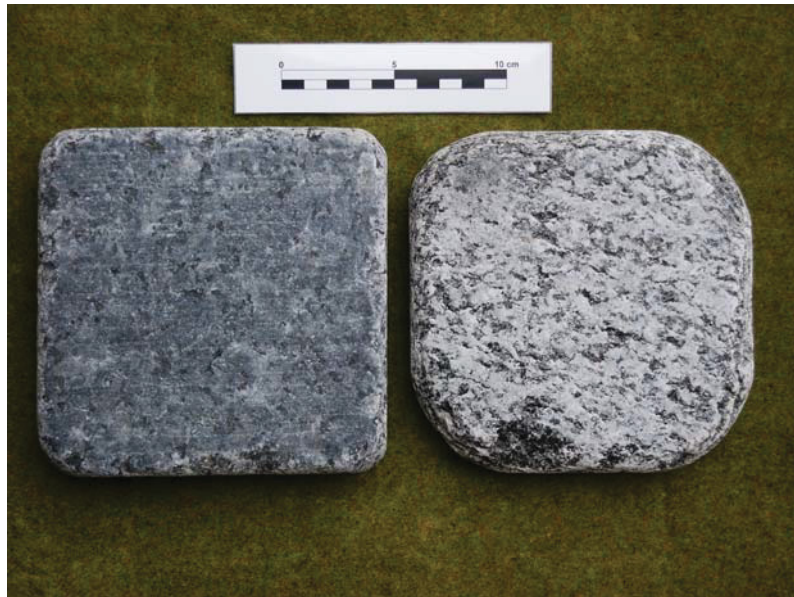
Abbildung 14: Abrundungsgrad im Vergleich Nero Assoluto (links) zu Serizzo (rechts)
