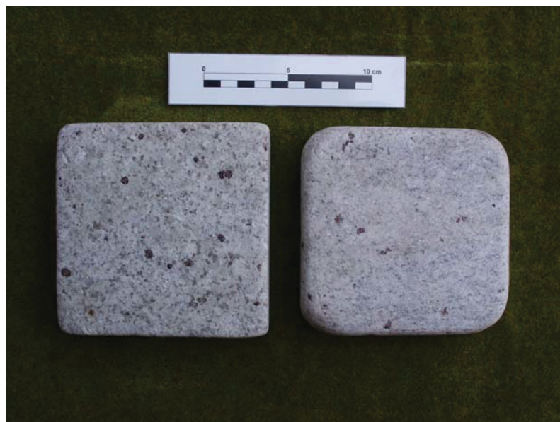
Abbildung 13: Abrundung nach 12 Stunden (Nr. 3, links) und 24 Stunden (Nr. 2, rechts)
