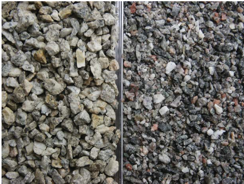
Abbildung 37: Vergleich Granitsand vom Steinbruch (links) mit aufbereitetem Granitsand (rechts)
