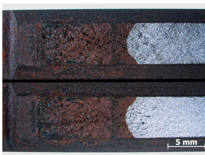
Abbildung 4.15: Repräsentative Bruchflächen nach DCPD-Messungen bei Prüfung nach NACE TM0177-2005 Methode D milden Bedingungen und anschließender Messung an Luft, Werkstoff: V3-S3 - 0,26C; 0,93Cr; 0,78Mo; ↑V; ↑↑Nb; ↑Ti; ↑B
