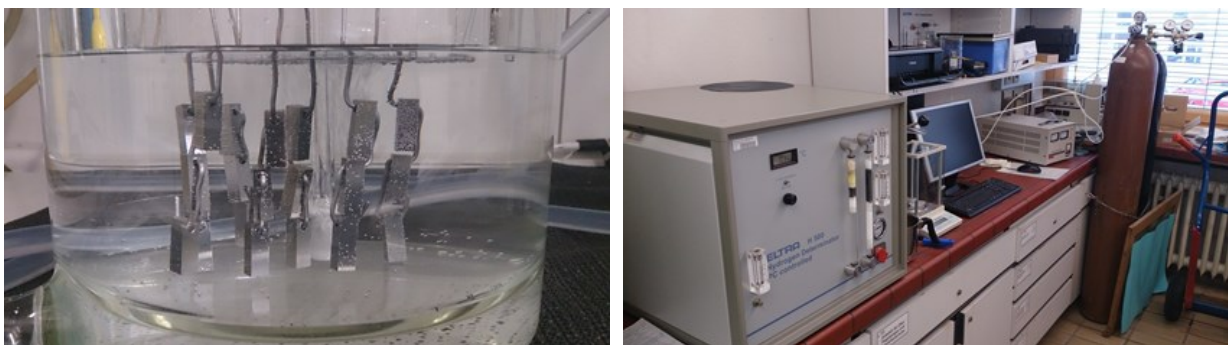
Abbildung 3.10: a) Auslagerung der Proben unter Methode D Standardbedingungen b) Analyseeinheit zur Bestimmung des Wasserstoffgehalts
