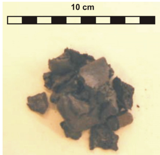
Abbildung 23: erstarre Schlacke Versuch C
