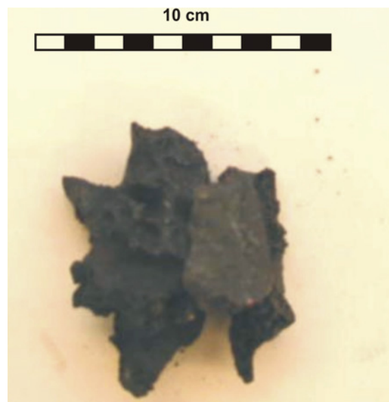
Abbildung 22: erstarre Schlacke Versuch B
