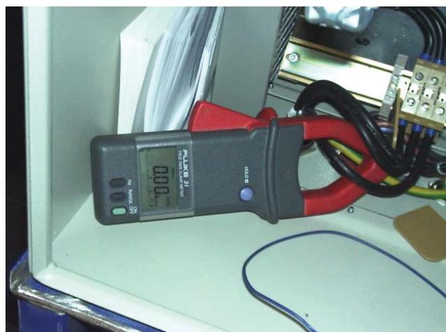
**Abbildung 5-3: Stromzange Fluke 31**
