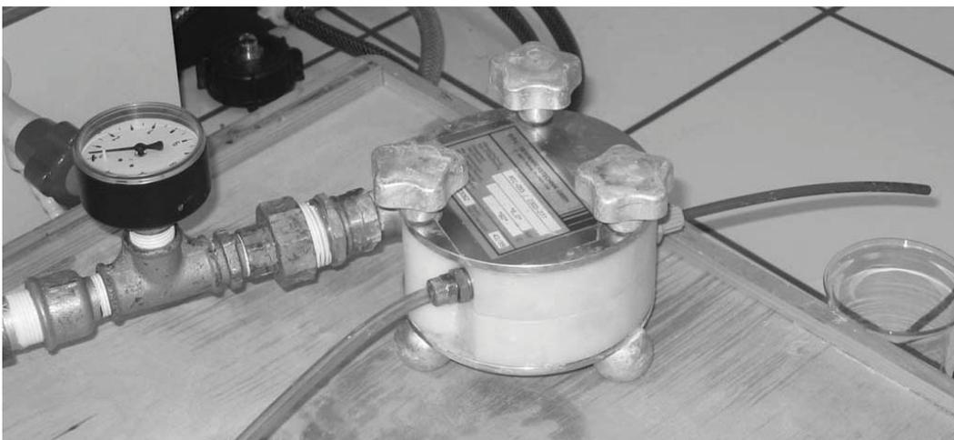
**Abbildung 9:** Membranmodul mit Manometer
