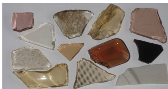
Abbildung 72: Typische farbliche Ausprägungen von Glaskeramik am Beispiel von Scherbenproben
