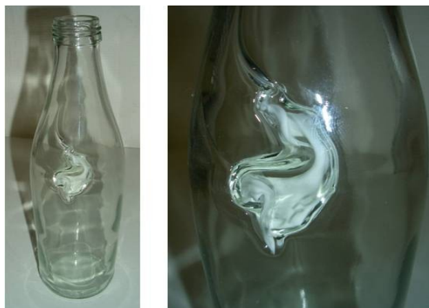
Abbildung 70: Glaskeramischer Einschluss in Behälterglasprodukt
