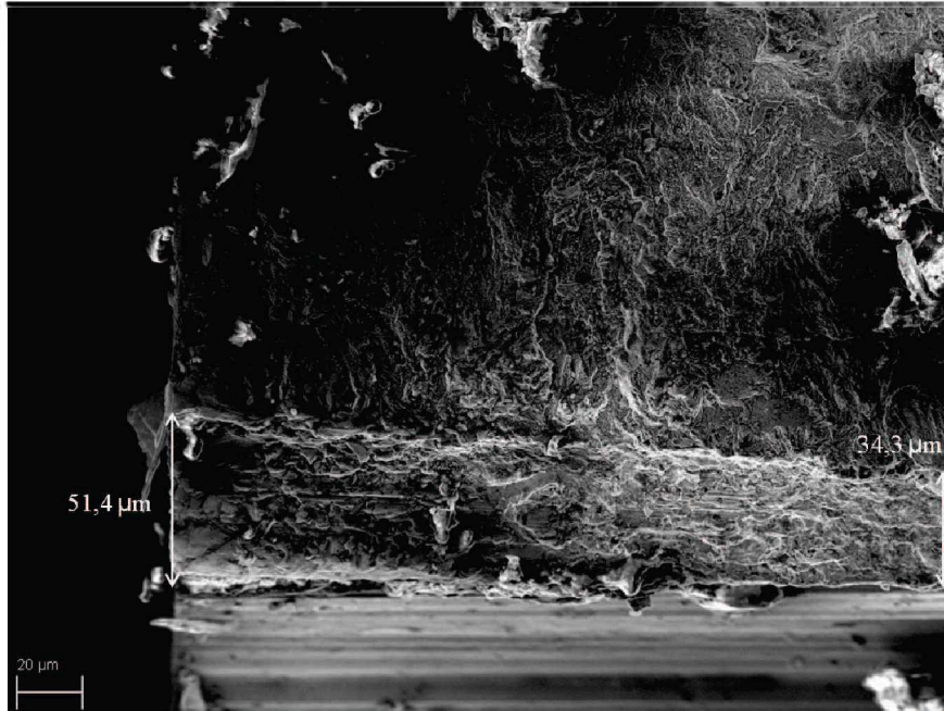
Abbildung 15: In der Rasterelektronenmikroskopie der Bruchfläche ist ein um 18 \mu m tieferer Rasierklingschnitt an der Außenseite zu beobachten. Dieser Unterschied könnte zu einem Fehler in der optischen Messung der Endrislänge nach dem Druckanspringen führen, vor allem bei kleinen Rissverlängerungen.
