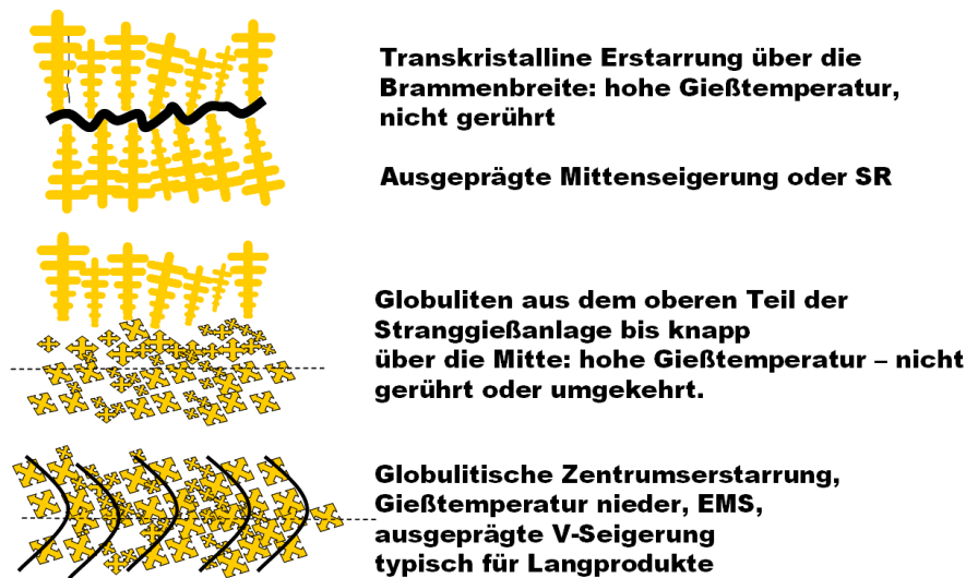
Abbildung 12: Ausbildung der Struktur im Strangzentrum für unterschiedliche Überhitzungen sowie den Einsatz von EMS. [JACOBI 1991]
