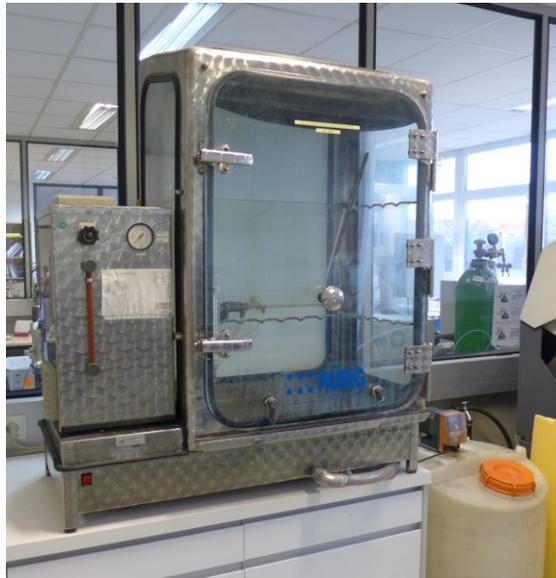
Abbildung 61: Kammer für Salzsprühtest nach DIN EN ISO 9227
