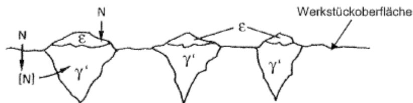
Abbildung 7: Schema zum Wachstum der Eisennitride. Durch Einlagerung von Stickstoff können ab einem Stickstoffgehalt von ca. 6mass%  $\gamma'$ -Nitride zu wachsen beginnen. Wird ein Stickstoffgehalt von 7,7mass% erreicht, bilden sich  $\epsilon$ -Nitride [15].
