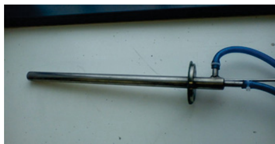
(d) Steel condenser
