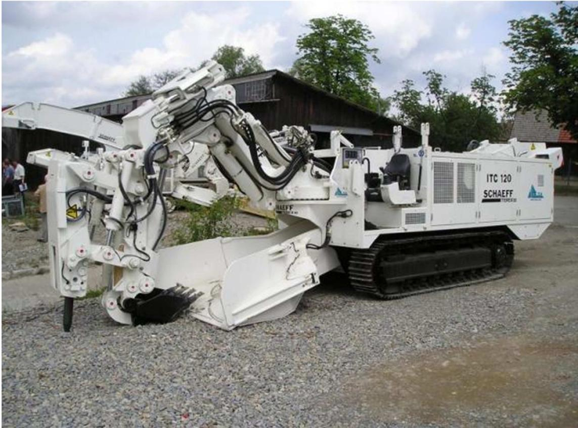
**Abbildung 3-4: Tunnelvortriebsbagger Terex - Schaeff ITC 120 (Bauforum 24)**
