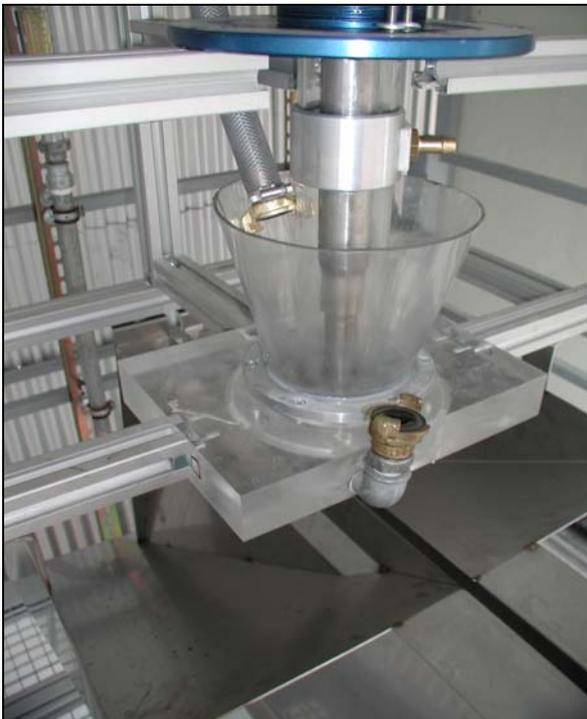
**Abbildung 5.9** Abdeckbleche zur teilweisen Ablenkung des Sprays
