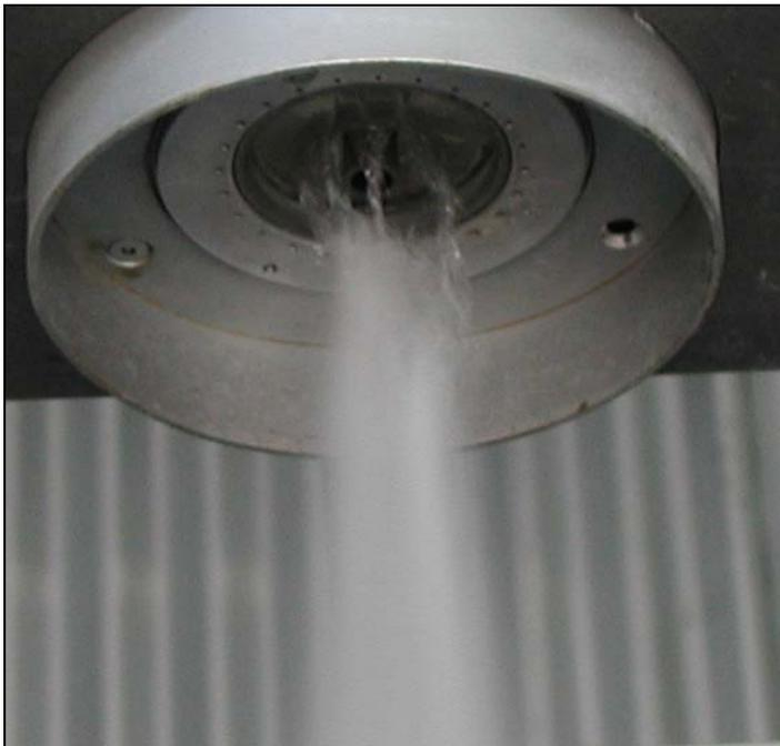
**Abbildung 6.10** Lavaldüse bei 3,5 bar und 6l/min; Position der Lavaldüse ist 4mm unterhalb der Auslaufdüse
