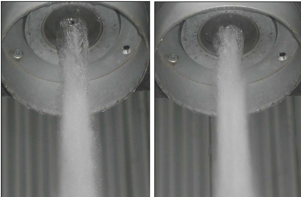
**Abbildung 6.4** Zerstäubung bei 2,5bar und 10l/min (linkes Bild) und Zerstäubung bei 6,5bar und 10l/min (rechtes Bild)
