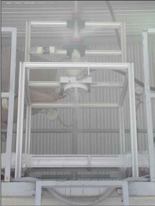
**Abbildung 6.17** Zerstäubung des Glykose-Sirups; Gesamtansicht
