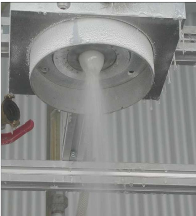
**Abbildung 6.18** Zerstäubung des Glykose-Sirups bei 3,5bar und 8l/min
