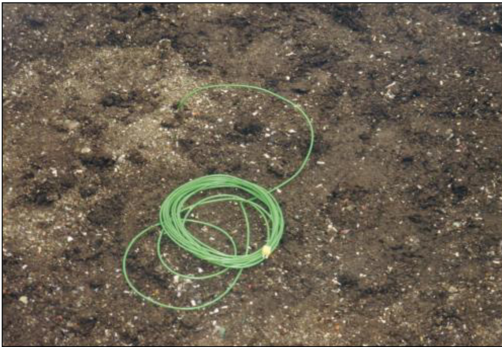
Abbildung 3.3: Thermofühlerkabel im eingebauten Material
