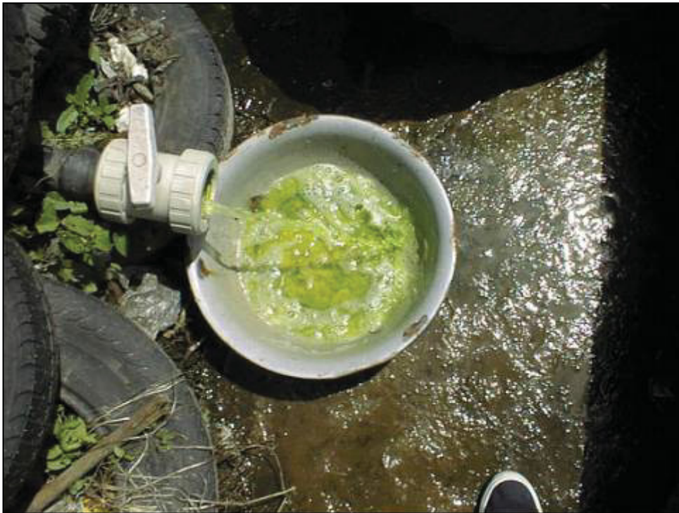
Abbildung 4.13: Sickerwasseraustritt, 1 Tag nach Bewässerung
