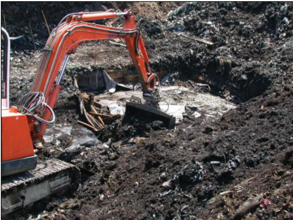
Abbildung 5.8: Minibagger für Feinarbeiten
