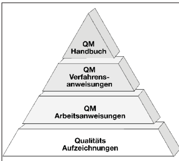
Abbildung 7: Aufbau der Dokumentation eines Qualitätsmanagementsystems [7, S.1]
