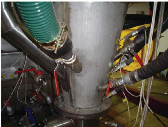
Abbildung 36: Kugelventile - Sekundärluft
