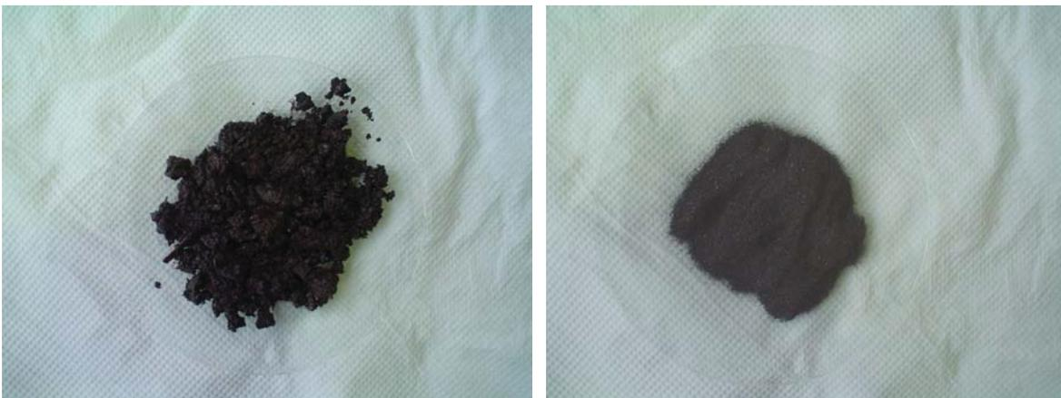
Abbildung 46: Kupfer(II)-oxid Zunder – Montanwerke Brixlegg
