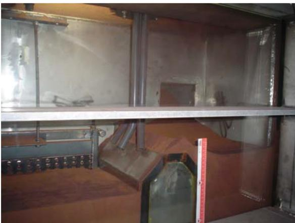
Abbildung 54: Aufgabevorrichtung für die Bestimmung der Impulsantwort
