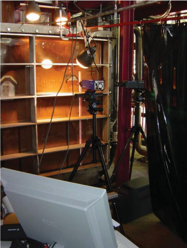
Abbildung 43: Versuchsaufbau PIV
