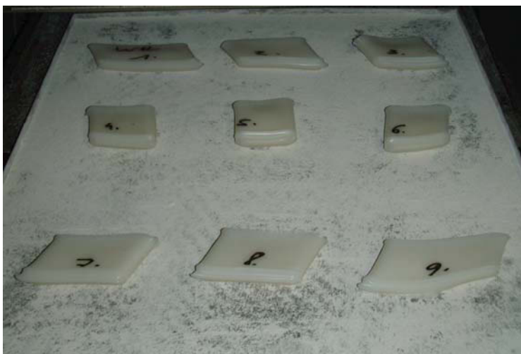
Bild 14: Geschrumpfte Platten nach dem Normtest
