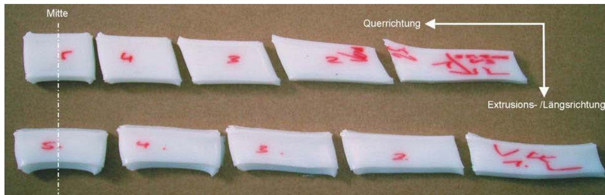
Bild 32: Plattestücke nach dem Normtest (oben Nr. 27, unten Nr. 28)
