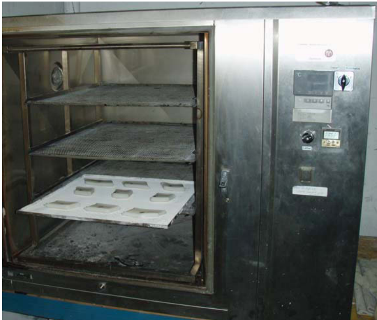
Bild 13: Warmluftofen mit ausgekühlten Prüflingen des Normtests
