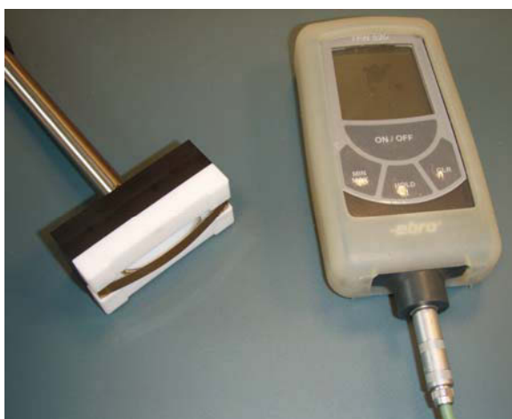
Bild 22: Kontaktthermoelement mit speziellem Messfühler für bewegte Oberflächen
