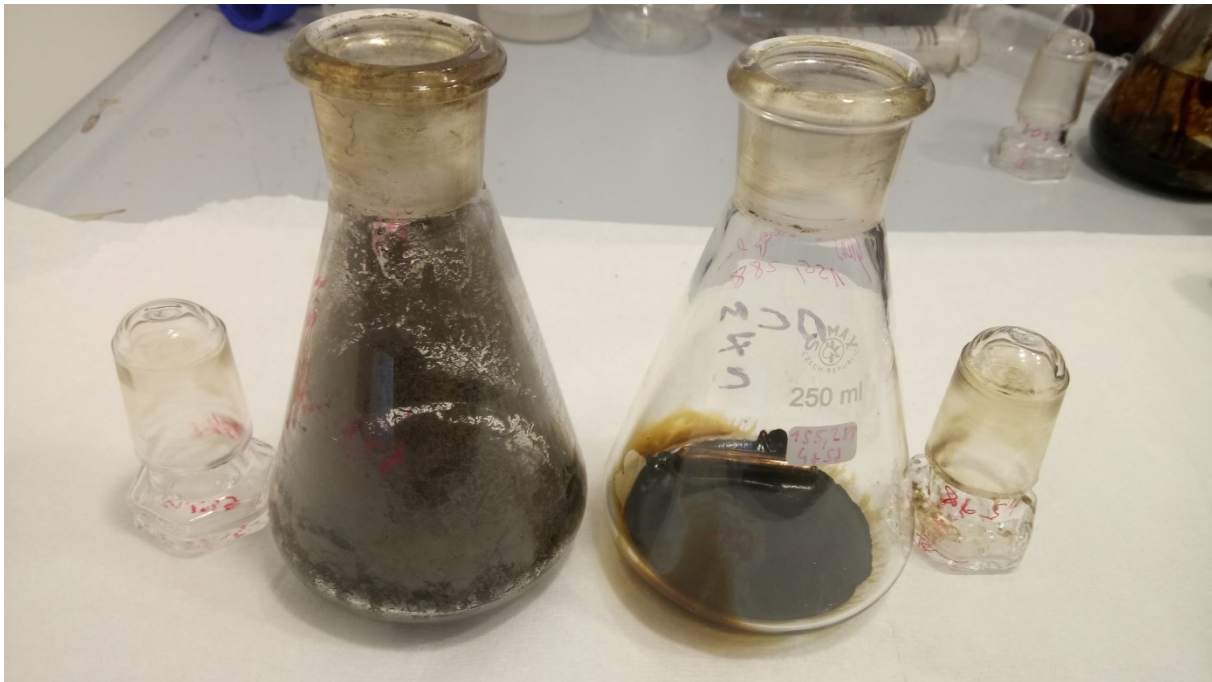
Abbildung 32: Vergleich der Ölphasen aus der Umsetzung von Klärschlamm (links) und Nannochloropsis -Algenpulver (rechts)
