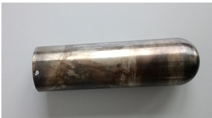
Abbildung 19: Stahleinsatz für den Probenraum
