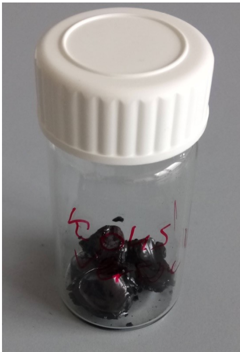
Abbildung 20: Koksartige Ablagerung im Scheidetrichter, leicht zerkleinert
