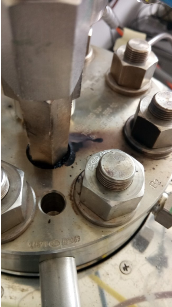
Abbildung 33: Ansatzbildung an der Verbindung von Deckel und Probenahmevertil des Autoklaven während der Versuche 5-9
