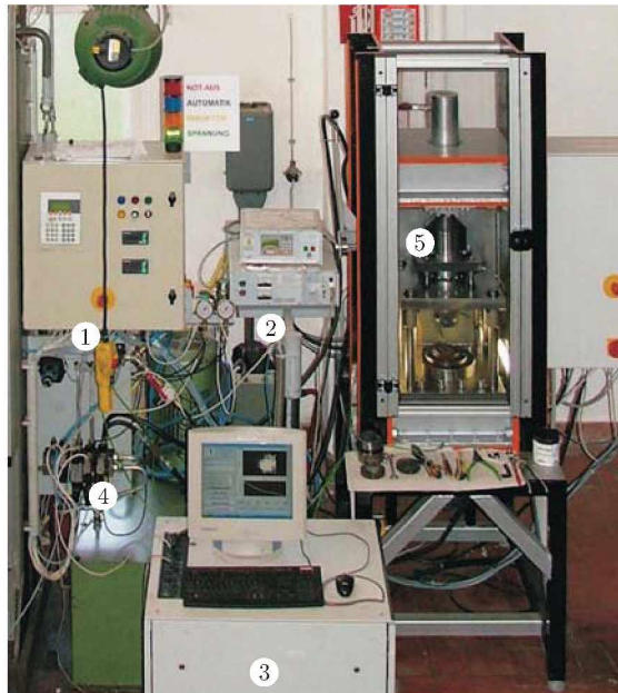
Abbildung 3.1: Überblick über die wichtigsten Anlagenteile. 1) Schutzschrank mit speicherprogrammierbarer Steuerung 2) Hochfrequenzgenerator für Induktor, 3) Datenerfassungssystem (Messrechner), 4) Hydraulikventilblock mit Druckbegrenzungs- und Steuerventil, 5) Rotationstribo-meter
