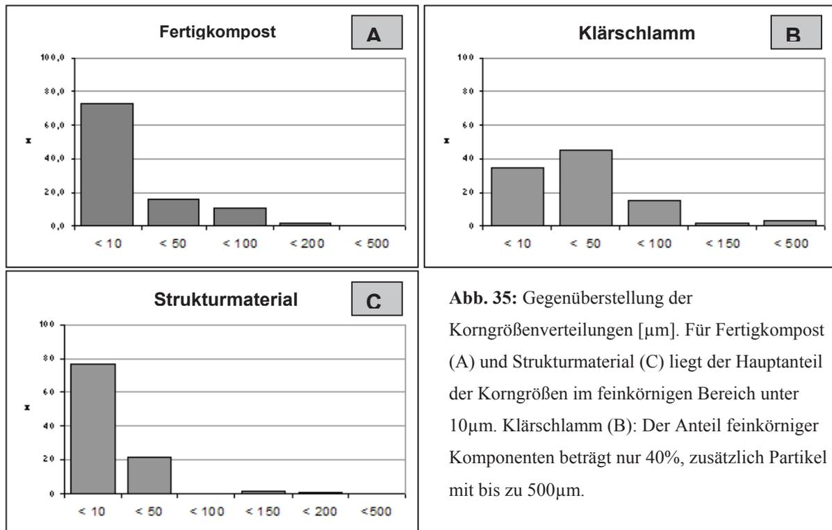
**Abb. 35:** Gegenüberstellung der Korngrößenverteilungen [μm]. Für Fertigkompost (A) und Strukturmaterial (C) liegt der Hauptanteil der Korngrößen im feinkörnigen Bereich unter 10μm. Klärschlamm (B): Der Anteil feinkörniger Komponenten beträgt nur 40%, zusätzlich Partikel mit bis zu 500μm.
