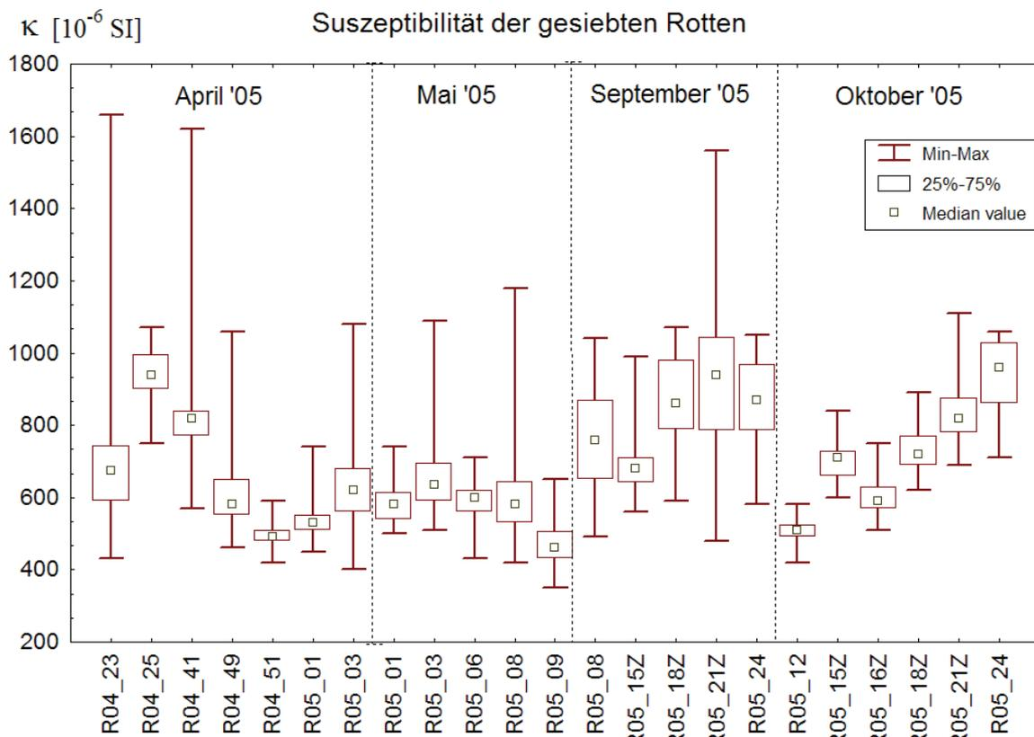
**Abb. 12:** Boxplotdarstellung der **Volumenssuszeptibilität**  $\kappa$  [ $10^{-6}$  SI] für die gesiebten Rotten
