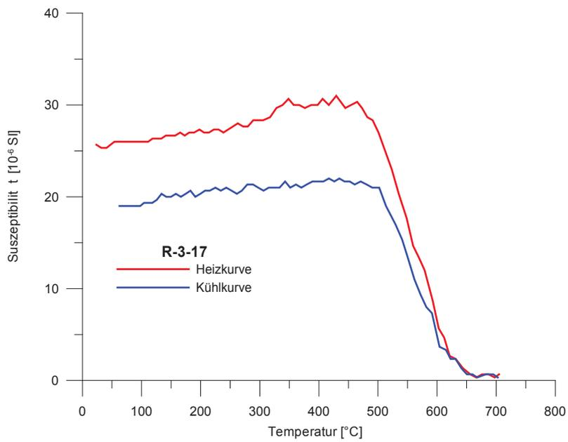
Temperaturabhängiger Suszeptibilitätsverlauf der Probe R-3-17 (Aufheizkurve rot); 2. Probenserie
