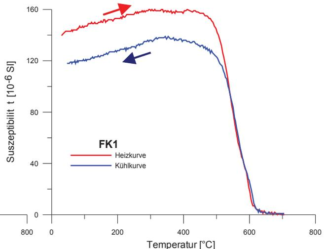
**Abb. 26:** Temperaturabhängiger Suszeptibilitätsverlauf der Probe FK 1 (Aufheizkurve rot)
