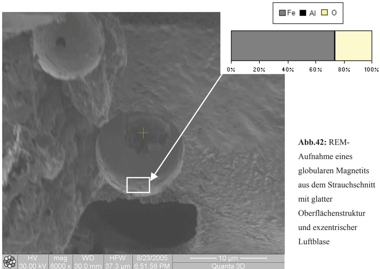
**Abb.42:** REM-Aufnahme eines globularen Magnetits aus dem Strauchschnitt mit glatter Oberflächenstruktur und exzentrischer Luftblase
