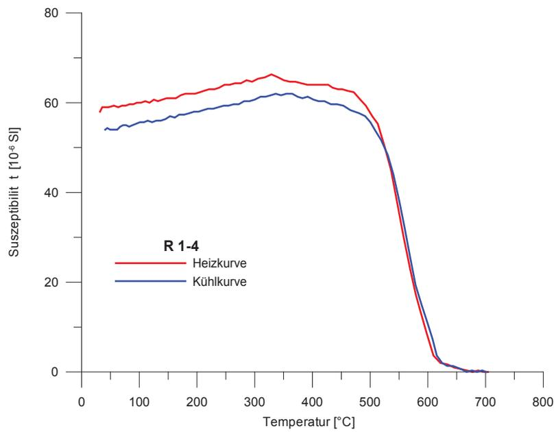
Temperaturabhängiger Suszeptibilitätsverlauf der Probe R1-4(Aufheizkurve rot); 2. Probenserie
