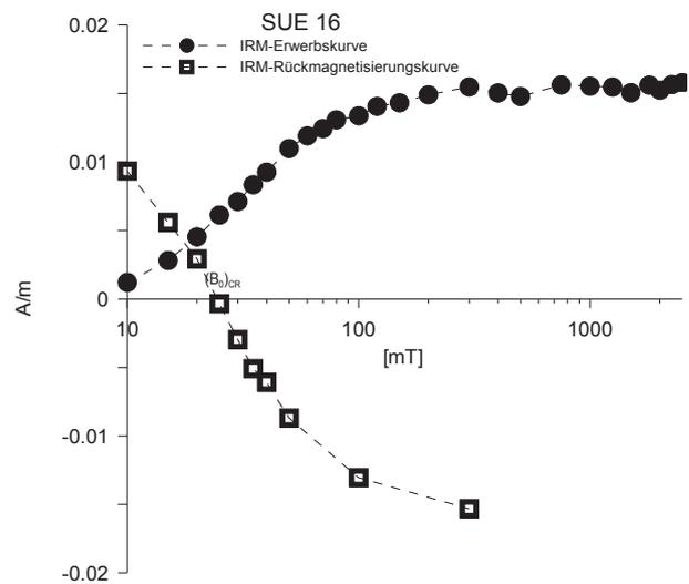
IRM-Erwerbs- und -Rückmagnetisierungskurven für die Proben RF 8, RF 12, RF17, RF 20, SUE 7 und SUE 16; 1. Probenserie
