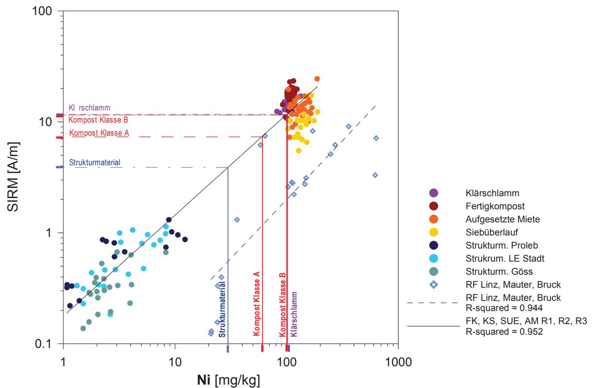
Grenzwerte laut Kompostverordnung 2001 für Strukturmaterial, Kompost und Klärschlamm und daraus abgeleitete magnetische Richtwerte (SIRM) für Hg und Ni
