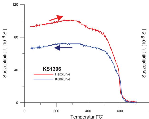
**Abb. 25:** Temperaturabhängiger Suszeptibilitätsverlauf der Probe KS1306 (Aufheizkurve rot)
