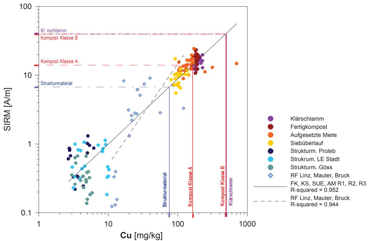
Grenzwerte laut Kompostverordnung 2001 für Strukturmaterial, Kompost und Klärschlamm und daraus abgeleitete magnetische Richtwerte (SIRM) für Cd und Cu
