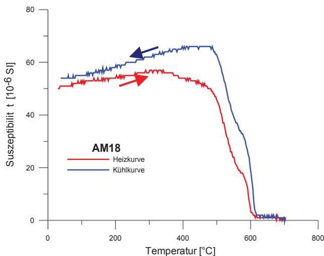
**Abb. 29:** Temperaturabhängiger Suszeptibilitätsverlauf der Probe AM 18 (Aufheizkurve rot)
