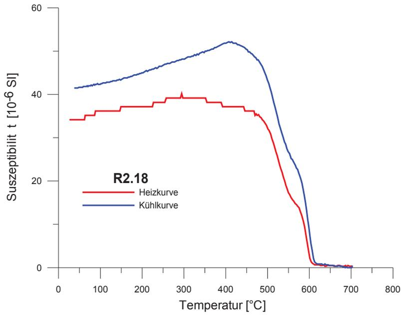
Temperaturabhängiger Suszeptibilitätsverlauf der Probe R2.18 (Aufheizkurve rot); 2. Probenserie
