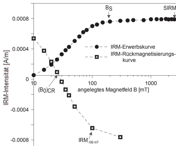
**Abb. 7:** IRM-Erwerbs – und –Rückmagnetisierungskurve der Probe RF-2 (Strukturmaterial „Region, Fremd“, Bruck - 2) mit einer Remanenzkoerzitivkraft (Nulldurchgang) von 27 mT. Die Sättigung ( $B_S$ ) wird bei einem Feld von ca. 200 mT fast vollständig erreicht. SIRM ist die maximal erreichbare IRM
