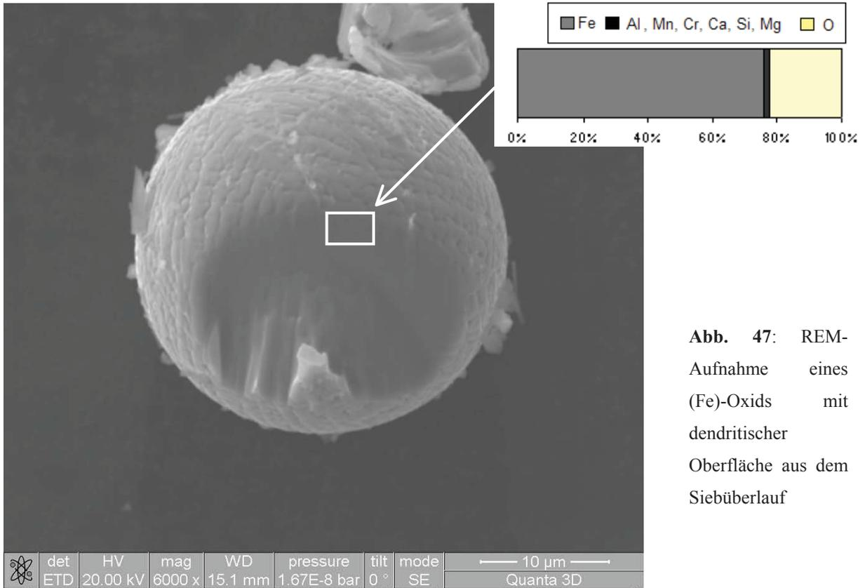
**Abb. 47:** REM-Aufnahme eines (Fe)-Oxids mit dendritischer Oberfläche aus dem Siebüberlauf
