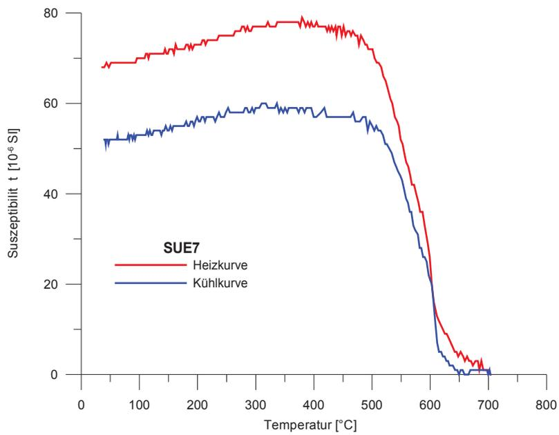
Temperaturabhängiger Suszeptibilitätsverlauf der Probe SUE 7(Aufheizkurve rot); 1. Probenserie
