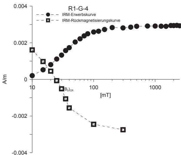
IRM-Erwerbs- und -Rückmagnetisierungskurven für die Proben R3-P-7, R3-P-17 FL 18, RF-M-28, R1-G20 und R1-G-4; 2. Probenserie
