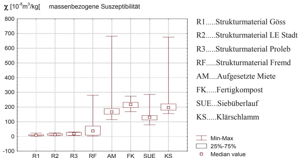
Abb. 13: Ergebnisse der Suszeptibilitätsmessungen in Boxplotdarstellung, 1. Probenserie
