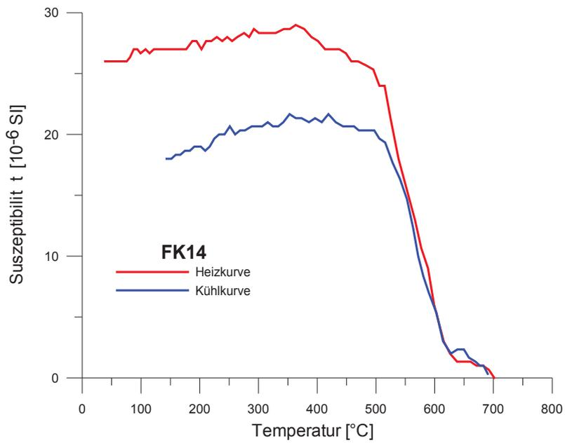
Temperaturabhängiger Suszeptibilitätsverlauf der Probe FK 14 (Aufheizkurve rot) ; 1. Probenserie
