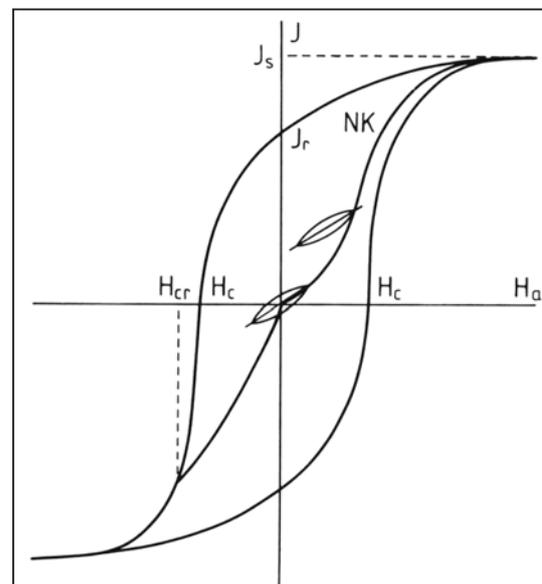
**Abb. 5:** Idealisierte Hystereseschleife;  $J$  Magnetisierung;  $H_a$  äußeres Magnetfeld;  $J_s$  Sättigungsmagnetisierung;  $J_r$  remanente Magnetisierung;  $H_c$  Koerzitivkraft;  $H_{cr}$  Remanenzkoerzitivkraft; NK Neukurve; (aus SOFFEL, 1991)
