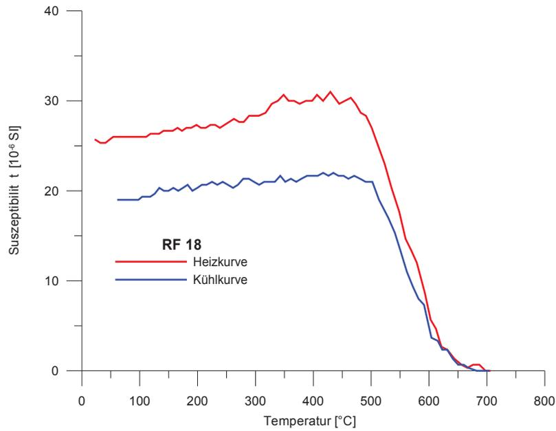
Temperaturabhängiger Suszeptibilitätsverlauf der Probe RF 18 (Aufheizkurve rot); 2. Probenserie
