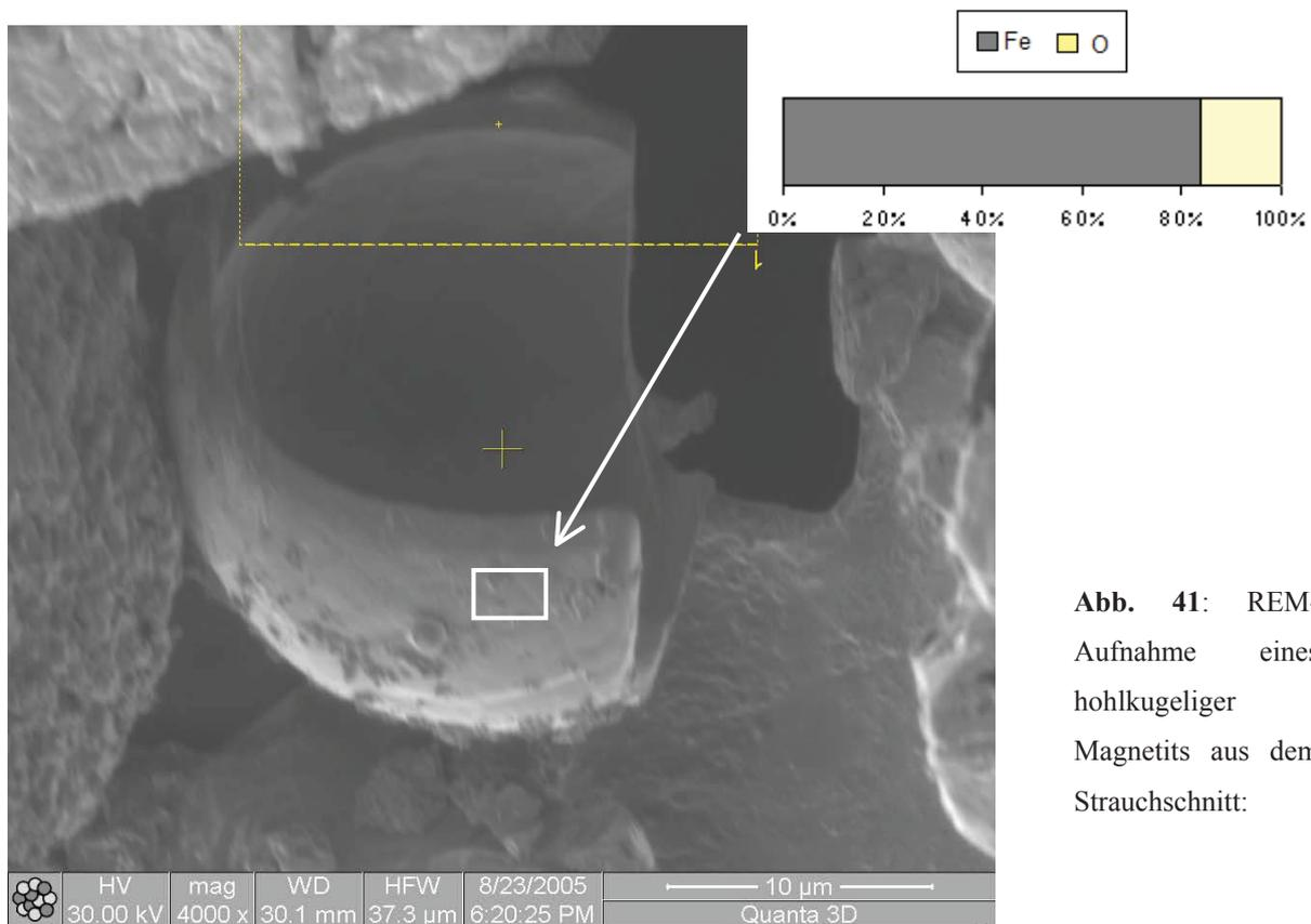
**Abb. 41:** REM-Aufnahme eines hohlkugeliger Magnetits aus dem Strauchschnitt:
