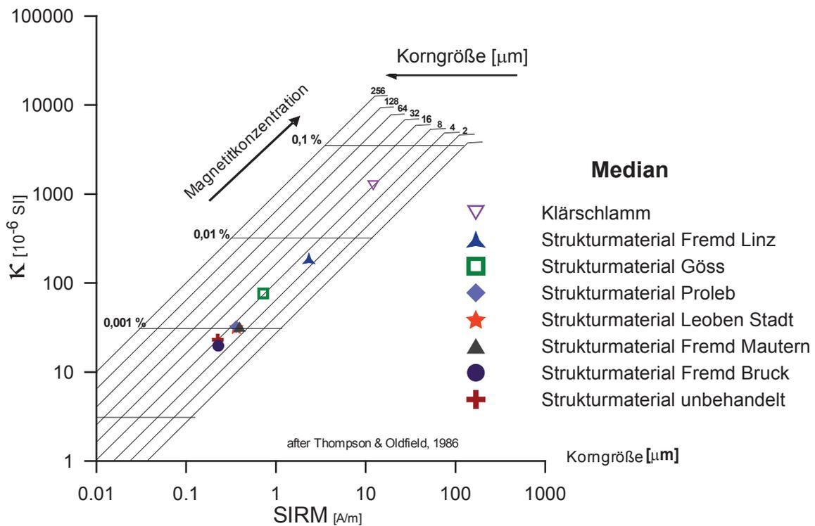
Abb. 18: Diagramm nach THOMPSON & OLDFIELD (1986), 2. Probenserie, Median
