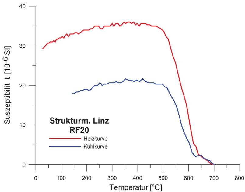
Temperaturabhängiger Suszeptibilitätsverlauf der Probe RF 20 (Aufheizkurve rot); 1. Probenserie
