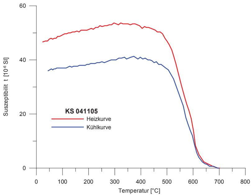
Temperaturabhängiger Suszeptibilitätsverlauf der Probe KS041105 (Aufheizkurve rot); 2. Probenserie
