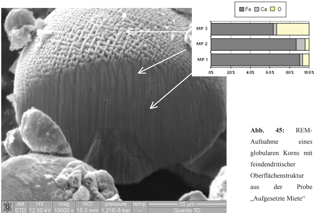
**Abb. 45:** REM-Aufnahme eines globularen Korns mit feindendritischer Oberflächenstruktur aus der Probe „Aufgesetzte Miete“
