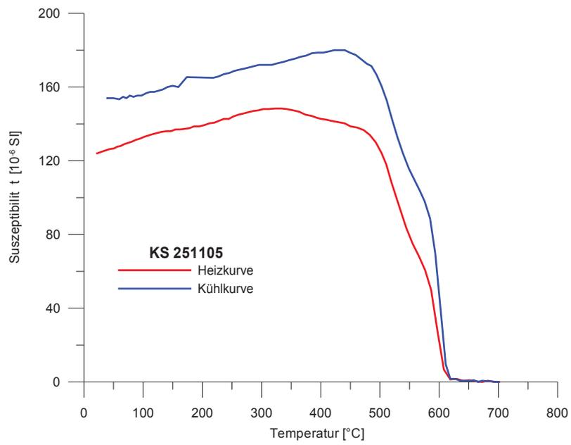
Temperaturabhängiger Suszeptibilitätsverlauf der Probe KS 251105 (Aufheizkurve rot); 2. Probenserie
