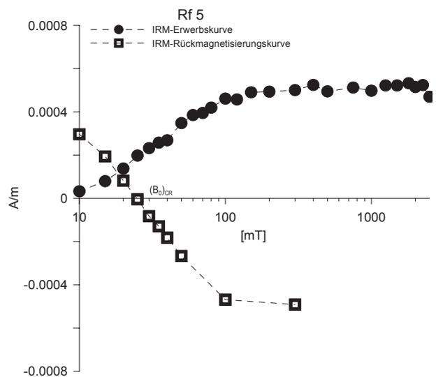
IRM-Erwerbs- und -Rückmagnetisierungskurven für die Proben R2/6, R2/9, R3/9, R3/12, RF2, RF5
