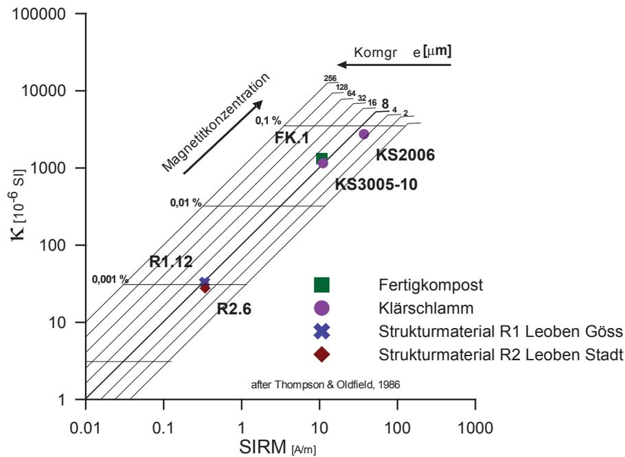
Abb. 49: Korngrößenabschätzung über das Diagramm nach THOMPSON & OLDFIELD (1986)
