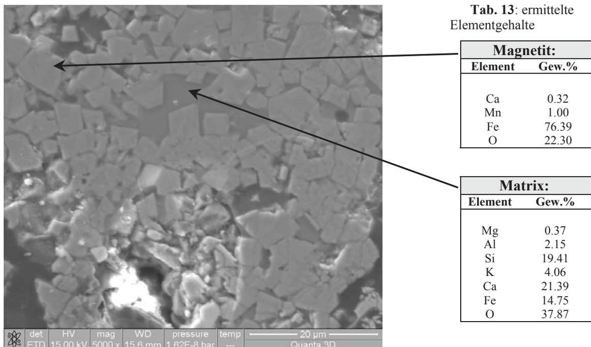
**Abb. 48:** REM-Aufnahme eines Sinterpartikels aus dem Klärschlamm
