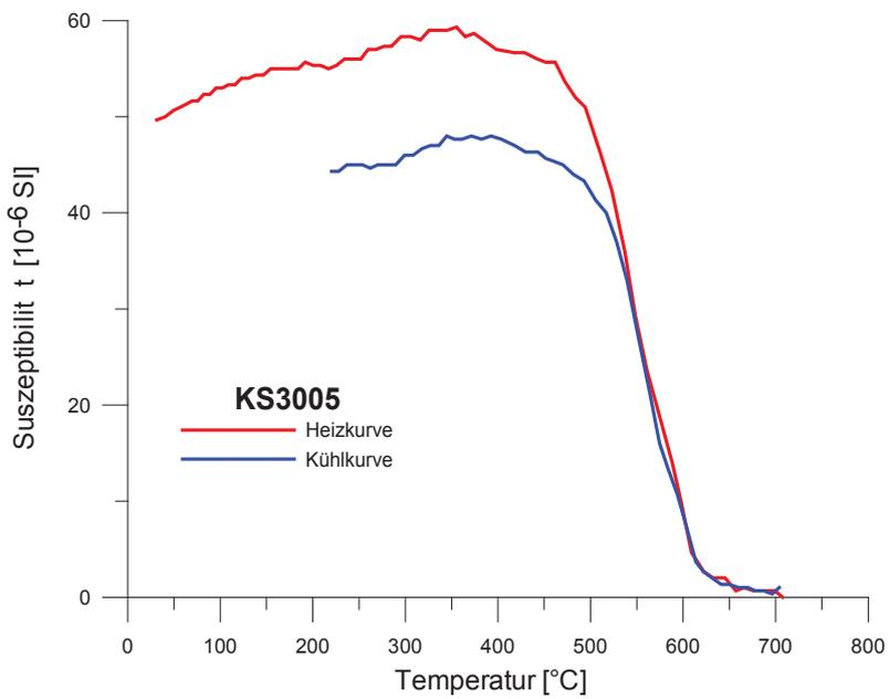
Temperaturabhängiger Suszeptibilitätsverlauf der Probe KS 3005-10 (Aufheizkurve rot) ; 1. Probenserie
