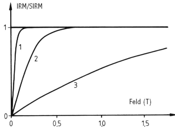
**Abb. 6:** Schematische Darstellung von IRM-Erwerbsskurven für verschiedene Ferrite (normiert); Typ 1: Magnetit, Maghemit, Titanomagnetit oder Magnetkies; Typ 2: Hämatit; Typ 3: Goethit (aus SOFFEL, 1991).
