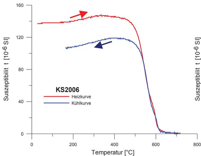
**Abb. 23:** Temperaturabhängiger Suszeptibilitätsverlauf der Probe KS2006 (Aufheizkurve rot)
