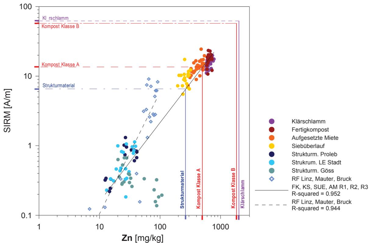
Grenzwerte laut Kompostverordnung 2001 für Strukturmaterial, Kompost und Klärschlamm und daraus abgeleitete magnetische Richtwerte (SIRM) für Pb und Zn
