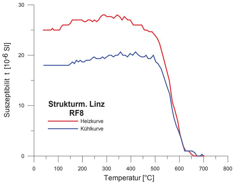
Temperaturabhängiger Suszeptibilitätsverlauf der Probe RF 8 (Aufheizkurve rot); 1. Probenserie
