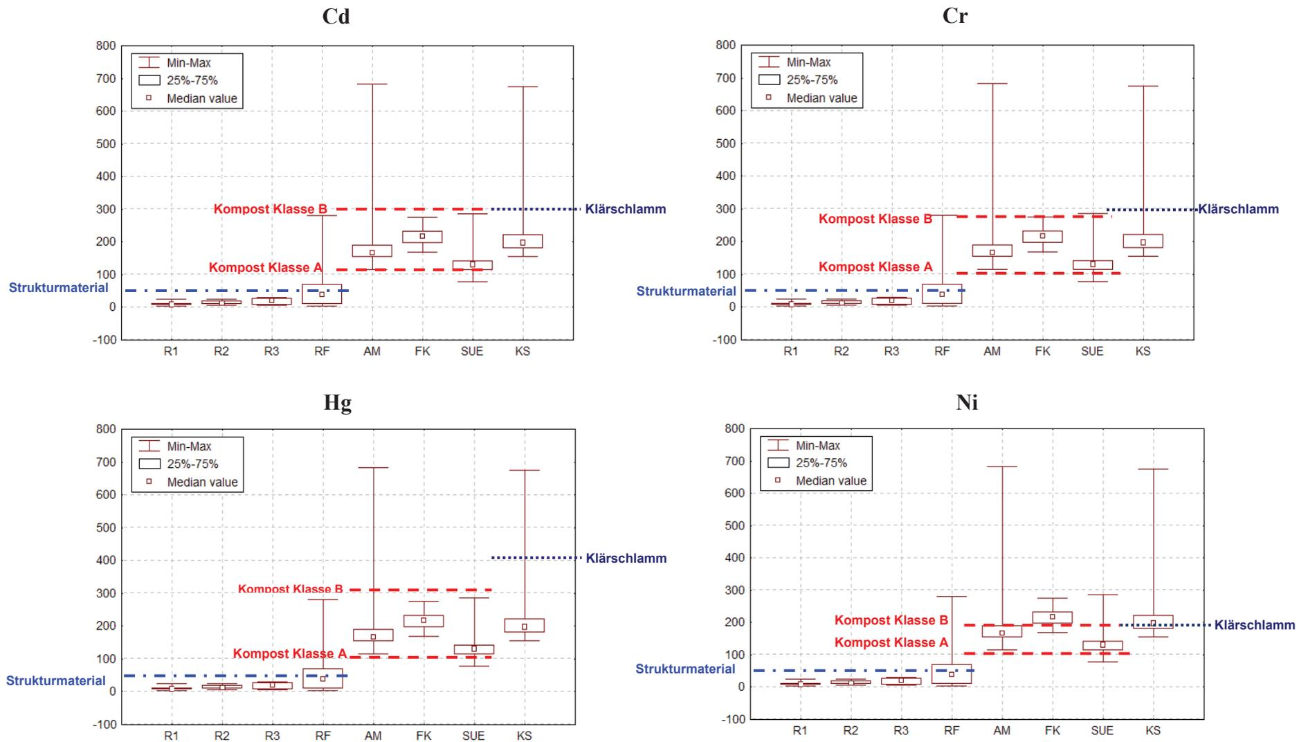
**Abb. 53:** magnetische Suszeptibilitäts-Richtwerte für Strukturmaterial, Kompost und Klärschlamm bezüglich der Elemente Cd, Cr, Hg und Ni, angewendet auf die Ergebnisse der 1..Probenserie (R1-Strukturmaterial Göss, R2-Strukturmaterial LE Stadt; R3-Strukturmaterial Proleb; RF-Strukturmaterial Fremd, AM-Aufgesetzte Miete, FK-Fertigkompost, SUE-Siebüberlauf, KS-Klärschlamm)
