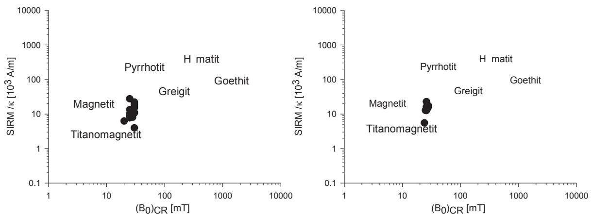
**Abb. 21:** Magnetische Unterscheidung von Mineralen nach PETERS & THOMPSON (1998),
