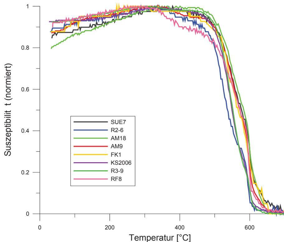
**Abb. 22:** Temperaturabhängige magnetische Suszeptibilität, Aufheizkurven (R2-Strukturmaterial LE Stadt; R3-Strukturmaterial Proleb; RF-Strukturmaterial Fremd, AM-Aufgesezte Miete, FK-Fertigkompost, SUE-Siebüberlauf, KS-Klärschlamm)
