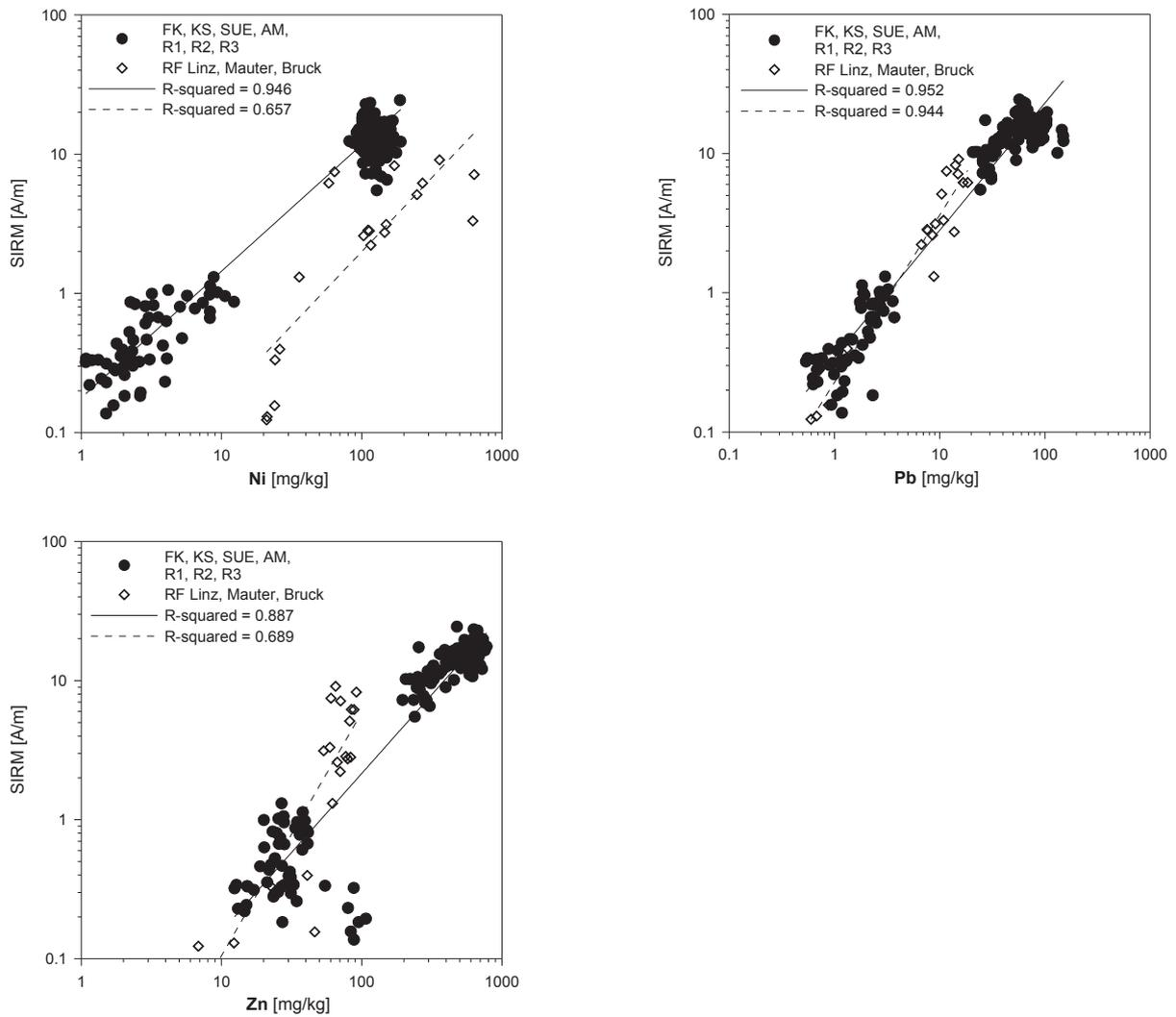
**Abb. 32:** Korrelation zwischen der remanenten Sättigungsmagnetisierung SIRM [A/m] und den Schwermetallen Ni, Pb, Zn [mg/kg], 1. Probenserie (R1-Strukturmaterial Göss, R2-Strukturmaterial LE Stadt; R3-Strukturmaterial Proleb; RF-Strukturmaterial Fremd, AM-Aufgesetzte Miete, FK-Fertigkompost, SUE-Siebüberlauf, KS-Klärschlamm)
