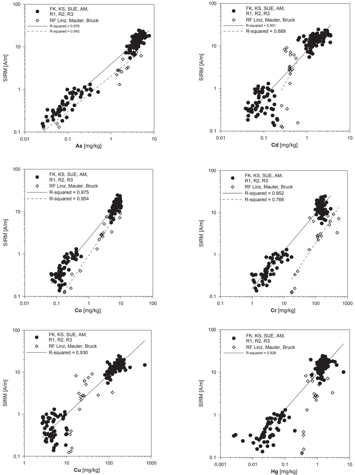
**Abb. 31:** Korrelation zwischen der remanenten Sättigungsmagnetisierung SIRM [A/m] und den Schwermetallen As, Cd, Co, Cr, Cu, Hg [mg/kg], 1. Probenserie (R1-Strukturmaterial Göss, R2-Strukturmaterial LE Stadt; R3-Strukturmaterial Proleb; RF-Strukturmaterial Fremd, AM-Aufgesetzte Miete, FK-Fertigkompost, SUE-Siebüberlauf, KS-Klärschlamm)
