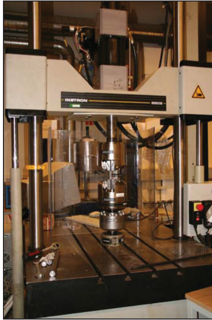
Abb. 5.1: 100 kN Instron Zugprüfmaschine
