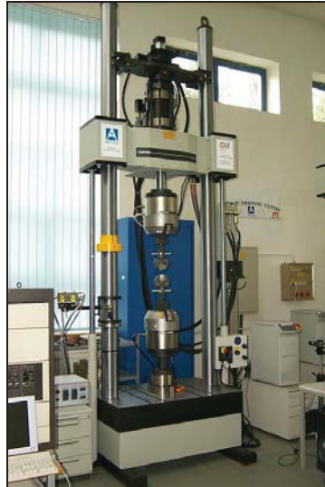
Abb. 5.6: Prüfmaschine für kombinierte Belastung von Zug und Torsion [36]
