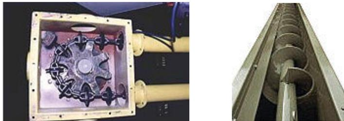
**Abb. 19:** Filteraustrag mit Rohrkettenförderer oder Austragsschnecke [ 5 ]
