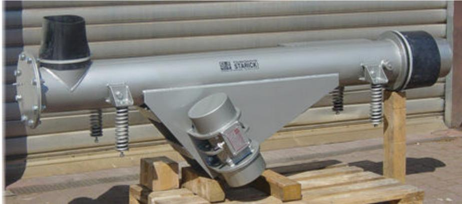
Abb. 42: Schwingförderrohr [ 14 ]
