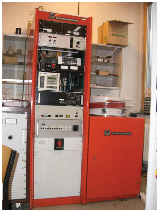
Abb.5- 1: Die für die Experimente verwendete Kathodenzerstäubungsanlage.
