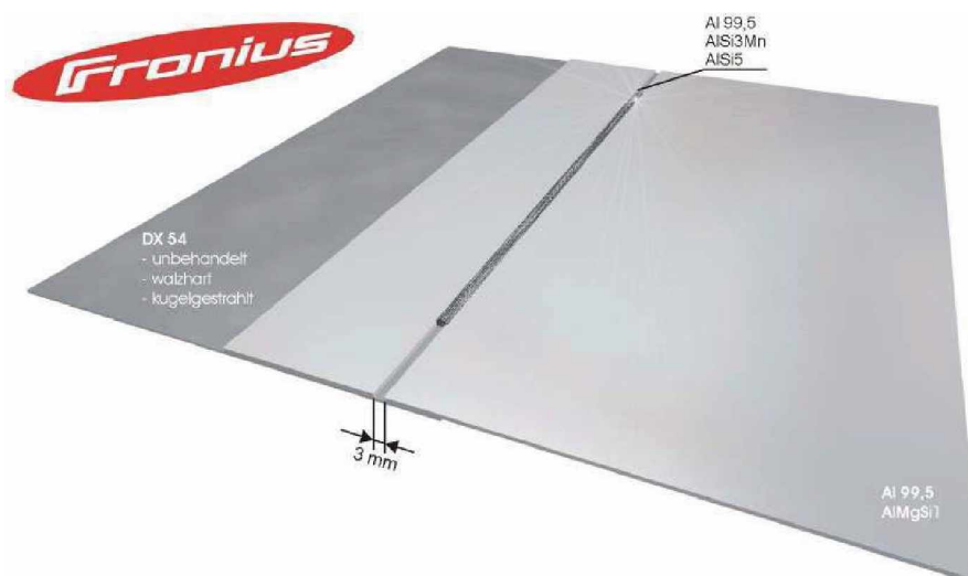
Abbildung 29: Schweißgeometrie im Überblick
