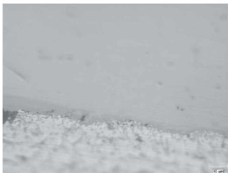
Abbildung 89: Schweißnahtende; links: Lichtmikroskop (500x), rechts: REM-EDX
