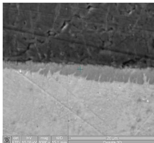
Abbildung 36: REM-Aufnahme: Al 99,5 – SG Al 99,5 – DX54 walzhart
