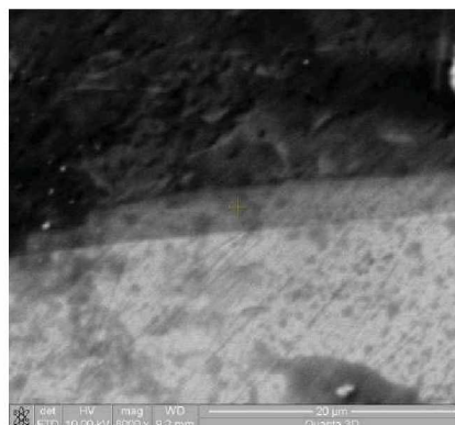
Abbildung 113: Schweißnahtanfang; links: Lichtmikroskop (500x), rechts: REM-EDX
