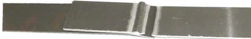
Abbildung 38: Duktiler Bruch im Aluminium (WEZ)
