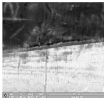
Abbildung 92: Schweißnahtende; links: Lichtmikroskop (500x), rechts: REM-EDX
