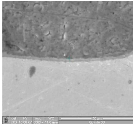
Abbildung 46: REM-Aufnahme: Al 99,5 – SG AISi5 – DX54 unbehandelt
