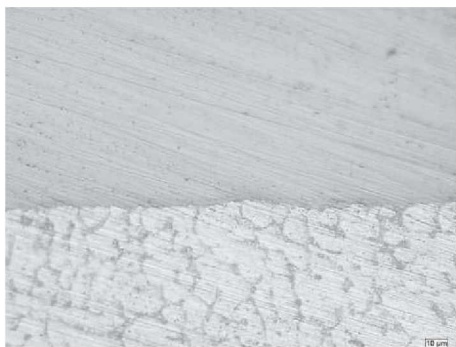
Abbildung 104: Schweißnahtende; links: Lichtmikroskop (500x), rechts: REM-EDX
