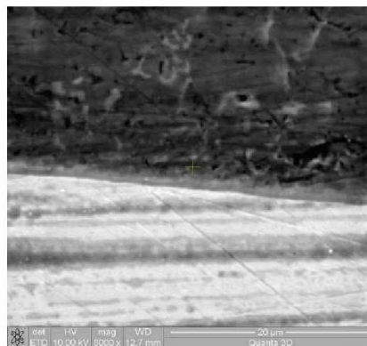
Abbildung 84: Schweißnahtmitte; links: Lichtmikroskop (500x), rechts: REM-EDX
