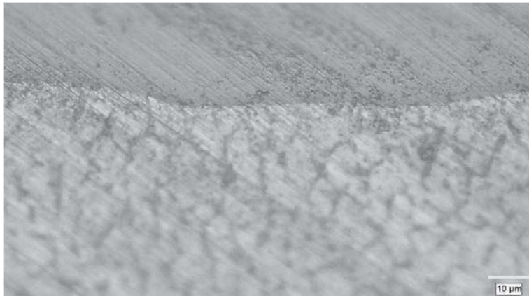
Abbildung 49: Schliffbild AIMgSi1 – SG AISi5 – DX54 walzhart 500x
