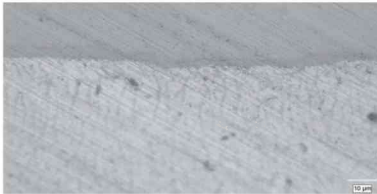
Abbildung 35: Schliffbild Al 99,5 – SG Al 99,5 – DX54 walzhart 500x
