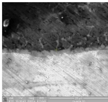
Abbildung 98: Schweißnahtanfang; links: Lichtmikroskop (500x), rechts: REM-EDX
