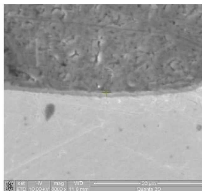
Abbildung 103: Schweißnahtmitte; links: Lichtmikroskop (500x), rechts: REM-EDX
