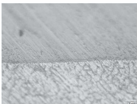
Abbildung 102: Schweißnahtanfang; links: Lichtmikroskop (500x), rechts: REM-EDX
