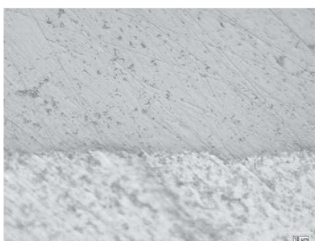
Abbildung 79: Schweißnahtanfang; links: Lichtmikroskop (500x), rechts: REM-EDX
