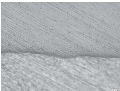
Abbildung 75: Schweißnahtmitte; links: Lichtmikroskop (500x), rechts: REM-EDX
