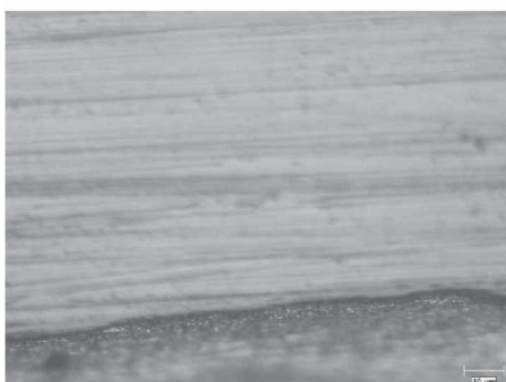
Abbildung 122: Schweißnahtmitte; links: Lichtmikroskop (500x), rechts: REM-EDX
