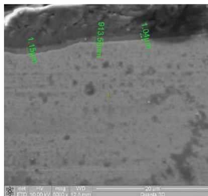
Abbildung 119: Schweißnahtende; links: Lichtmikroskop (500x), rechts: REM-EDX
