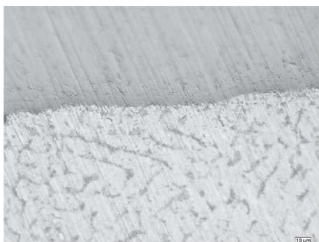
Abbildung 99: Schweißnahtmitte; links: Lichtmikroskop (500x), rechts: REM-EDX
