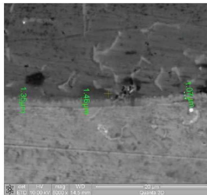
Abbildung 118: Schweißnahtmitte; links: Lichtmikroskop (500x), rechts: REM-EDX
