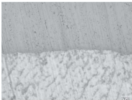
Abbildung 95: Schweißnahtmitte; links: Lichtmikroskop (500x), rechts: REM-EDX
