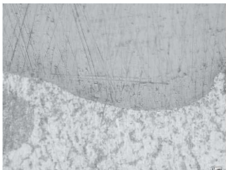
Abbildung 122: Schweißnahtmitte; links: Lichtmikroskop (500x), rechts: REM-EDX
