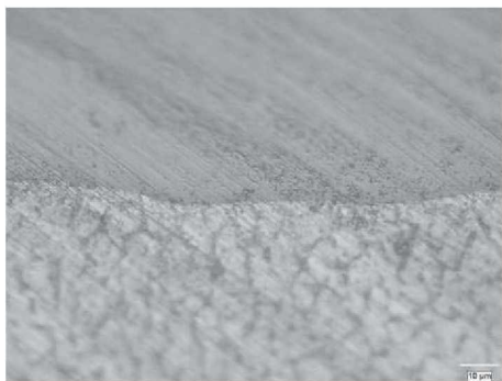
Abbildung 118: Schweißnahtmitte; links: Lichtmikroskop (500x), rechts: REM-EDX
