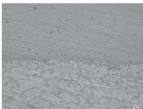
Abbildung 83: Schweißnahtanfang; links: Lichtmikroskop (500x), rechts: REM-EDX
