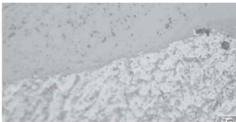
Abbildung 42: Schlibbild AIMgSi1 – SG Al 99,5 – DX54 walzhart 500x
