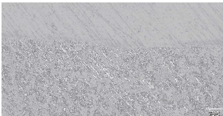
Abbildung 53: Schliffbild Al 99,5 – SG AlSi3Mn – DX54 unbehandelt 500x
