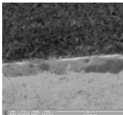
Abbildung 75: Schweißnahtmitte; links: Lichtmikroskop (500x), rechts: REM-EDX
