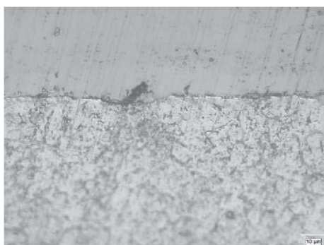
Abbildung 91: Schweißnahtmitte; links: Lichtmikroskop (500x), rechts: REM-EDX
