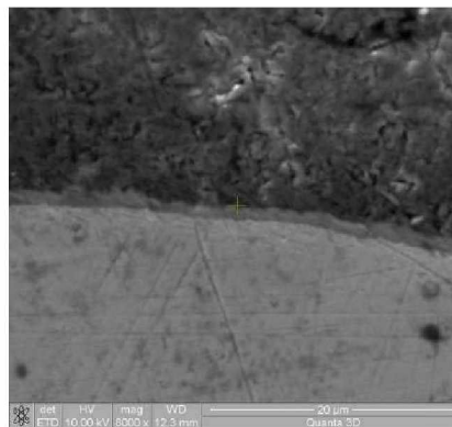
Abbildung 104: Schweißnahtende; links: Lichtmikroskop (500x), rechts: REM-EDX
