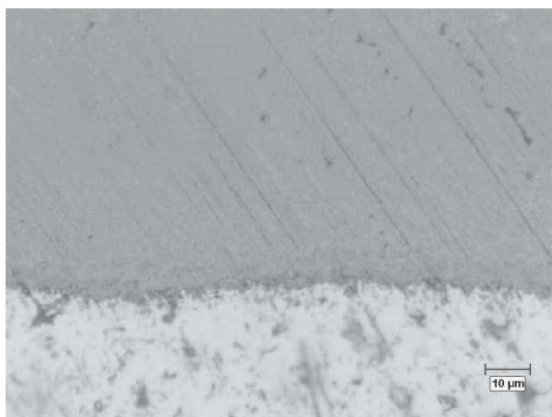
Abbildung 138: Schweißnahtmitte; links: Lichtmikroskop (500x), rechts: REM-EDX
