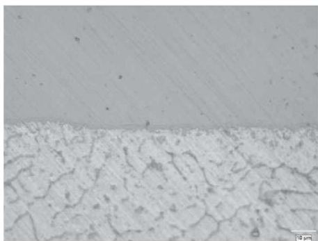
Abbildung 96: Schweißnahtende; links: Lichtmikroskop (500x), rechts: REM-EDX
