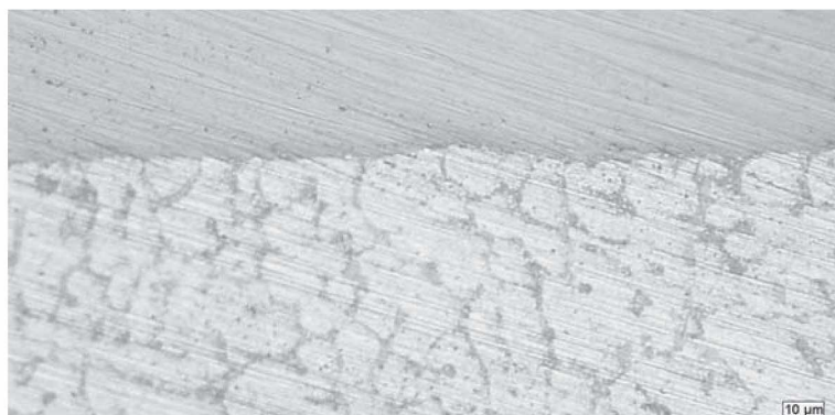
Abbildung 45: Schliffbild Al 99,5 – SG AISi5 – DX54 unbehandelt 500x
