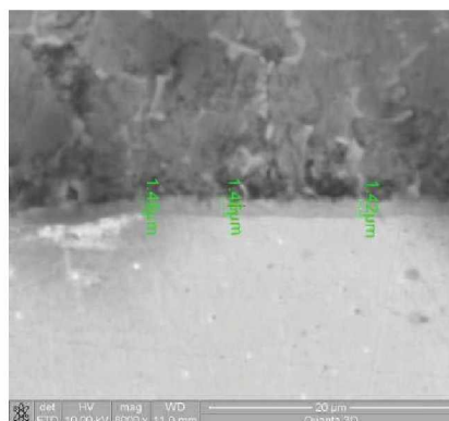
Abbildung 79: Schweißnahtanfang; links: Lichtmikroskop (500x), rechts: REM-EDX
