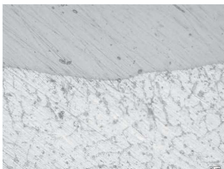
Abbildung 111: Schweißnahtmitte; links: Lichtmikroskop (500x), rechts: REM-EDX
