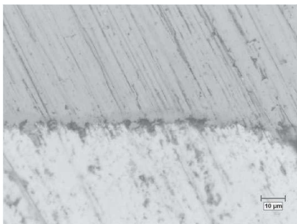
Abbildung 134: Schweißnahtanfang; links: Lichtmikroskop (500x), rechts: REM-EDX
