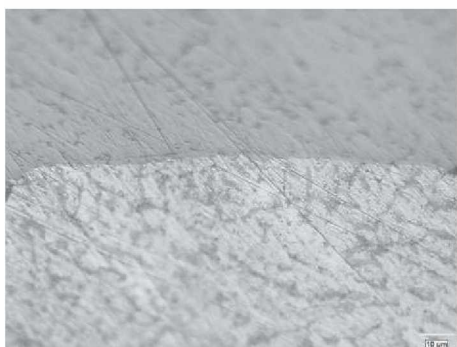
Abbildung 113: Schweißnahtanfang; links: Lichtmikroskop (500x), rechts: REM-EDX
