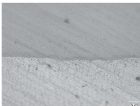
Abbildung 66: Schweißnahtmitte; links: Lichtmikroskop (500x), rechts: REM-EDX
