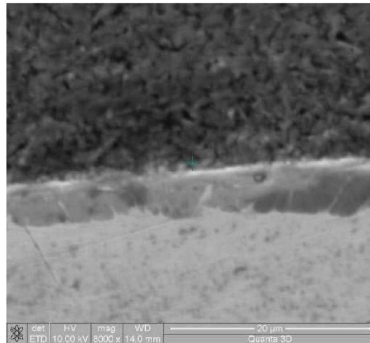
Abbildung 43: REM-Aufnahme: AlMgSi1 – SG Al 99,5 – DX54 walzhart
