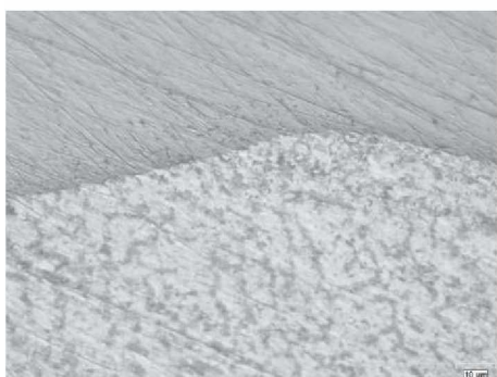
Abbildung 87: Schweißnahtanfang; links: Lichtmikroskop (500x), rechts: REM-EDX
