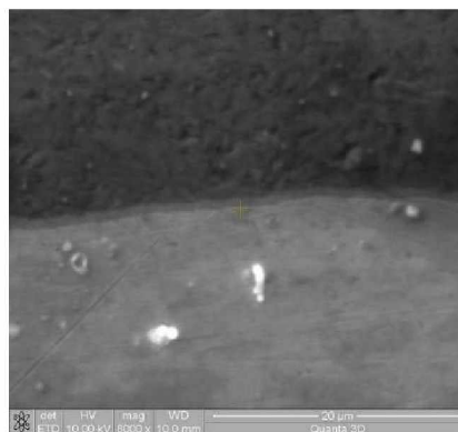
Abbildung 102: Schweißnahtanfang; links: Lichtmikroskop (500x), rechts: REM-EDX
