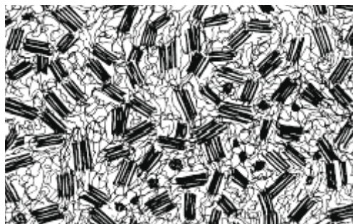
Abb. 2.8: Schema der Überstruktur bestehend aus Hart- und Weichsegmenten (Dieterich, 1993)
