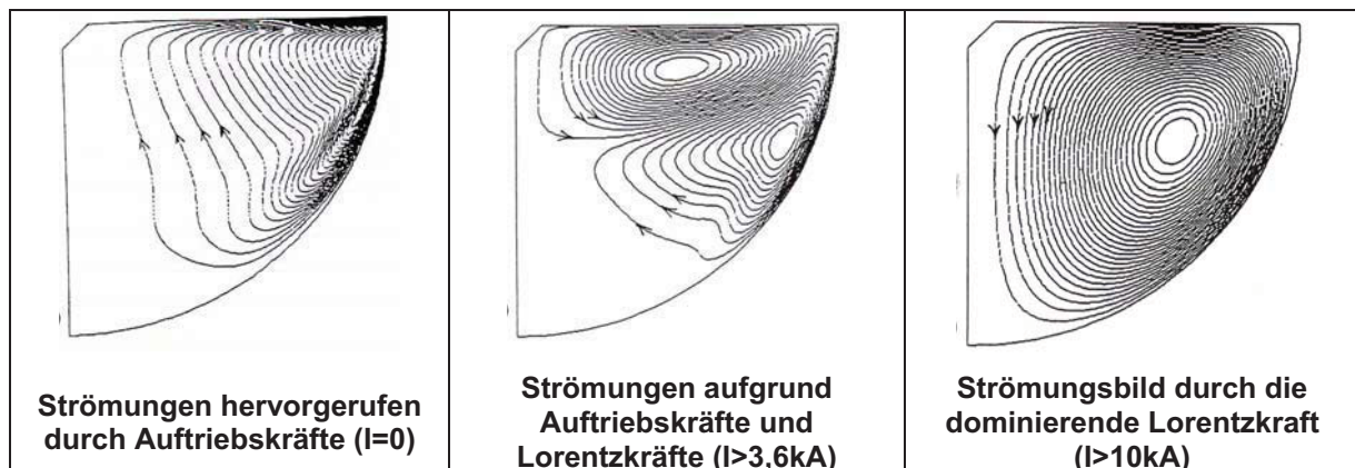
Abbildung 2-5: Veränderung des Strömungsbildes mit zunehmenden Schmelzstrom [19]
